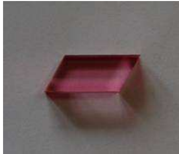
Figure 4.2. Le cristal de Ti :Sa utilisé dans les expériences. Le cristal est long de 1.2cm et il est taillé à l'angle de Brewster.
