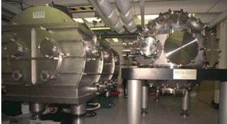
Figure 3.3 – Photo de la salle expérimentale du laser 100 TW au LULI, présentant le compresseur sous vide (gauche) et l'enceinte d'interaction (droite).
