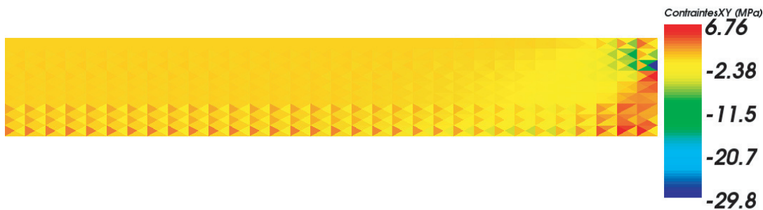
FIGURE 4.72 – Champ de contraintes \sigma_{XY} à t=5 s
