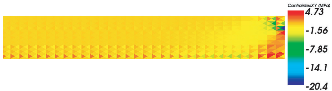
FIGURE 4.70 – Champ de contraintes \sigma_{XY} au début de la phase de refroidissement
