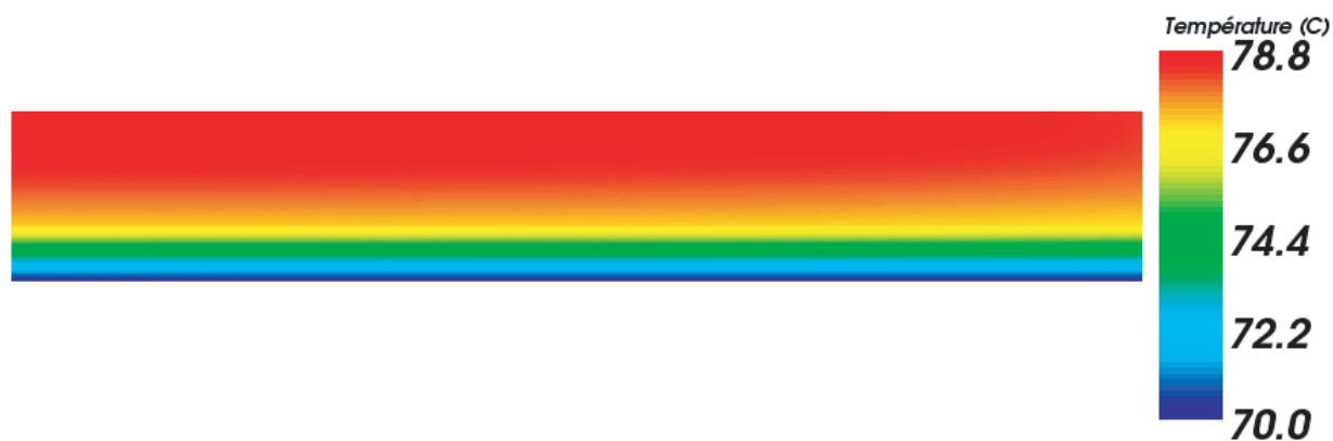
FIGURE 4.79 – Champ de température (°C) à t=5 s de la phase de refroidissement
