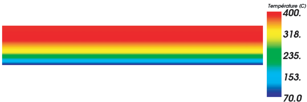
FIGURE 4.68 – Champ de température ( ^{\circ}\text{C} ) au début de la phase de refroidissement
