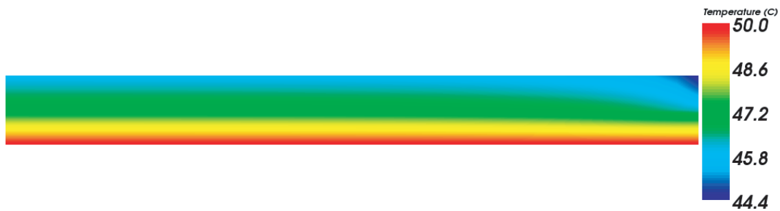
FIGURE 4.19 – Champ de température ( ^{\circ}C ) en fin de phase de refroidissement, t=10 s
