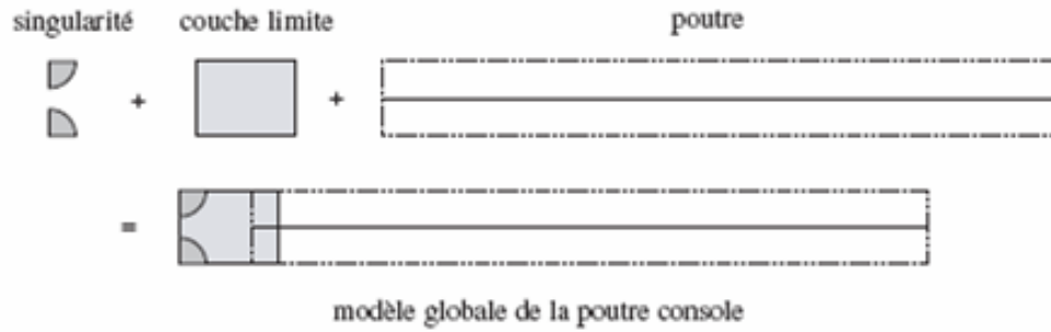
FIGURE 2.8 – Exemple de modélisation Arlequin
