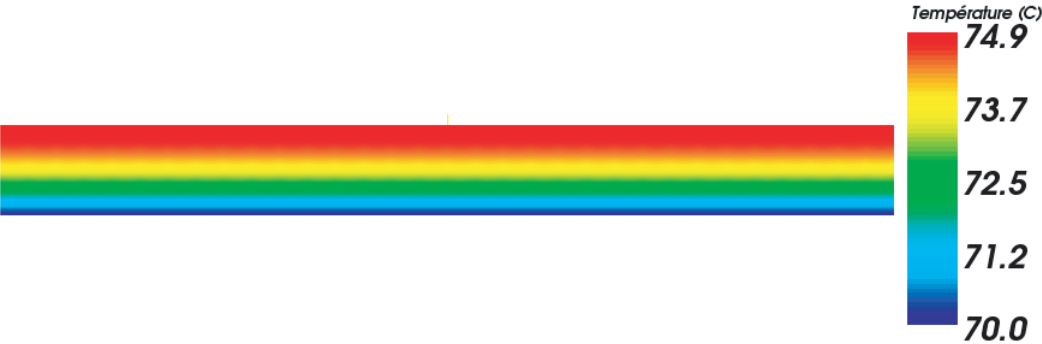
FIGURE 4.38 – Champ de température (°C) à t=1 s de la phase de refroidissement
