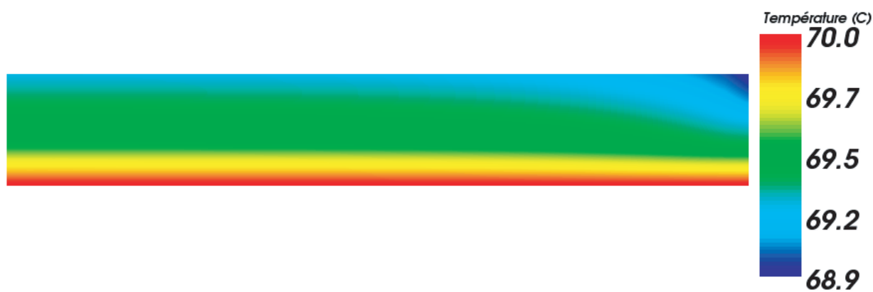
FIGURE 4.80 – Champ de température (°C) en fin de phase de refroidissement
