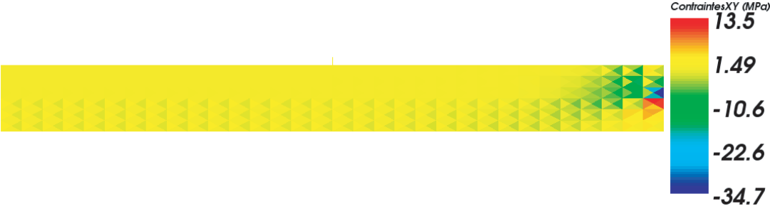
FIGURE 4.31 – Champ de contraintes \sigma_{XY} à t=5 s
