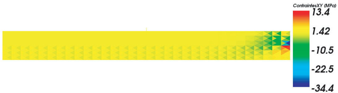
FIGURE 4.29 – Champ de contraintes \sigma_{XY} au début de la phase de refroidissement
