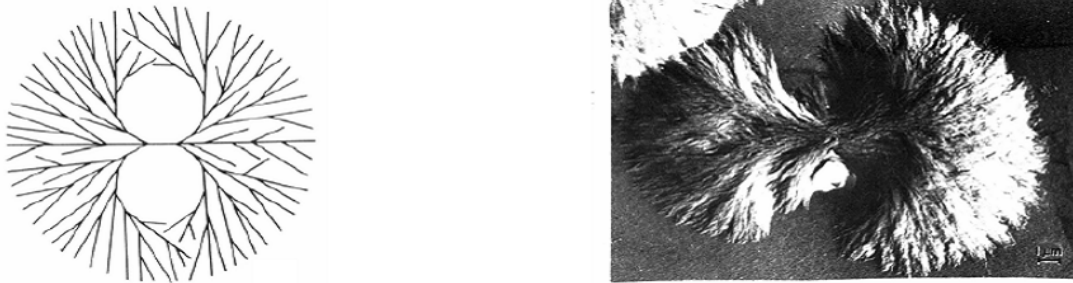
FIGURE 1.21 – Représentation schématique d'un sphérolite
