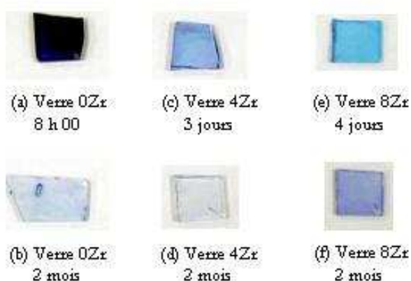
Figure 5-4 : Imprégnation par une solution de bleu de méthylène des verres altérés à pH 7 aux temps courts et après deux mois d'altération.
