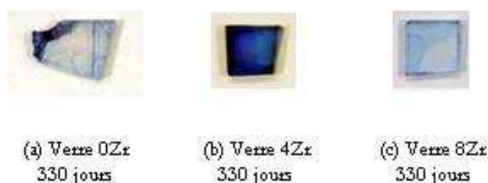
Figure 5-5 : Imprégnation par une solution de bleu de méthylène après 330 jours d'altération à pH 8.
