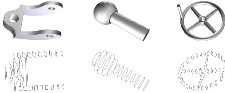
FIG. 4.14 – Trois modèles 3D et leurs coupes respectives le long d'une direction [103].
