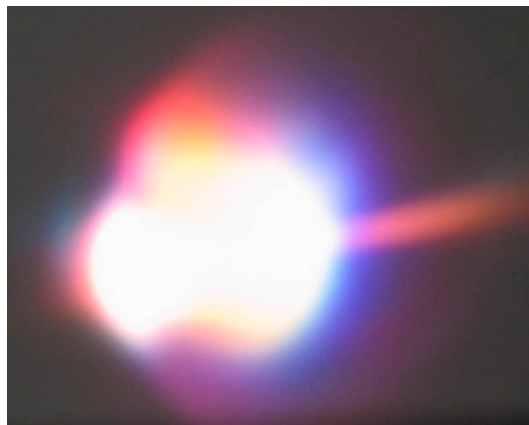
FIG. 4.3 – Structure spatiale transverse de multi-filamentation. L'impulsion initiale possède une énergie de 2,5 mJ et une polarisation linéaire. La pression d'argon est de 1500 mbar. Le temps d'intégration est de 30 ms.
