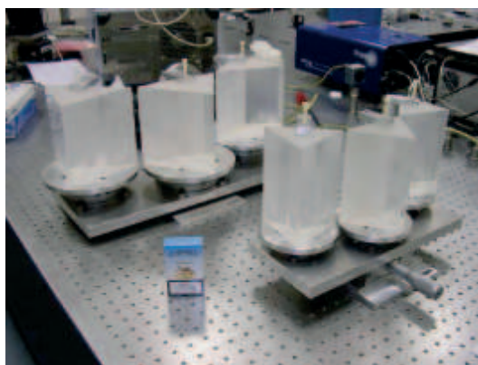
FIG. 3.14 – Prismes en silice utilisés dans le compresseur de la chaîne. Le paquet de cigarettes permet de se faire une idée de la taille peu commune de ces prismes.
