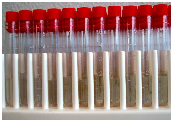
Figure 79 : DU3/D/7, Images des effluents collectés durant les étapes de traçages monophasiques à l'eau peu salée : (a) de 50g/l à 1g/l, (b) de 1g/l à 0,1g/l, T = 90°C.
