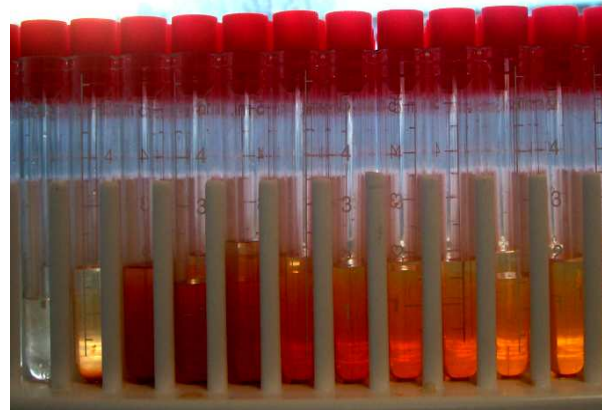
Figure 79 : DU3/D/7, Images des effluents collectés durant les étapes de traçages monophasiques à l'eau peu salée : (a) de 50g/l à 1g/l, (b) de 1g/l à 0,1g/l, T = 90°C.
