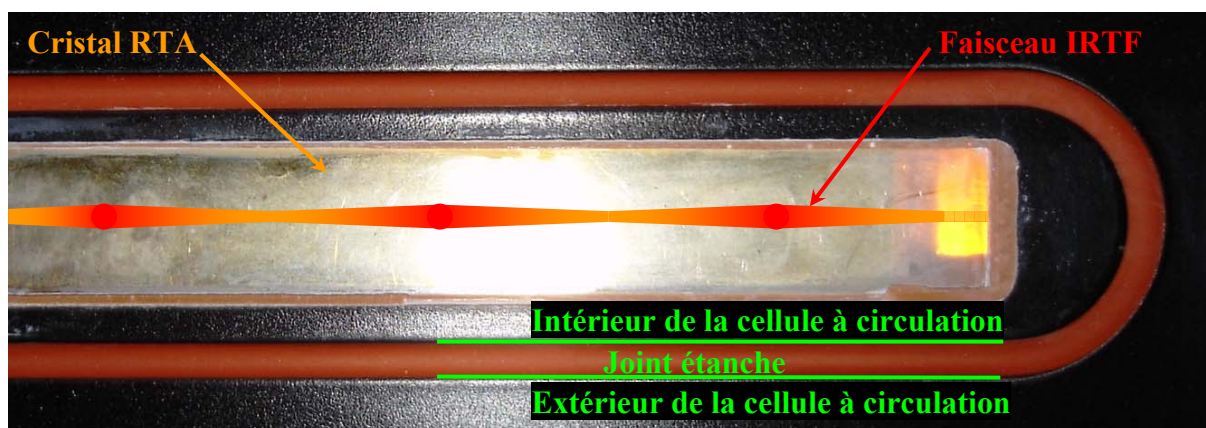
Figure 2: photographie de l'intérieur d'une cellule RTA montrant un cristal ZnSe typiquement utilisé lors des expériences. Celui-ci est recouvert d'une couche de colloïdes de corindon (« aspect blanchâtre »).
