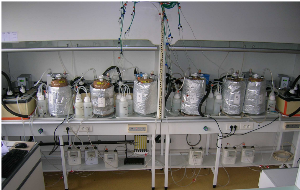
Schéma et photographie du dispositif de compostage miniaturisé (utilisé les 41 premiers jours du compostage) comprenant 6 réacteurs fonctionnant en parallèle, compatible avec l'utilisation de molécules radiomarquées.
