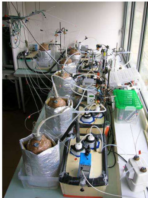
Schéma et photographie du dispositif de compostage miniaturisé (utilisé les 41 premiers jours du compostage) comprenant 6 réacteurs fonctionnant en parallèle, sans utilisation de marquage ^{14}C .
