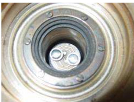
Figure 35 : Photo d'un module de DSC avec ses deux capsules (l'une vide et l'autre contenant le matériau à tester)
