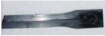
Figure 91 : Photographie de PA66 après 50 à 200h heures de vieillissement dans l'antigel à 140°C
