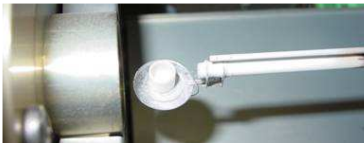
Figure 36 : Photo d'un creuset de thermogravimétrie sur la nacelle équipée de thermocouples et reliée à une microbalance avant son introduction dans le four
