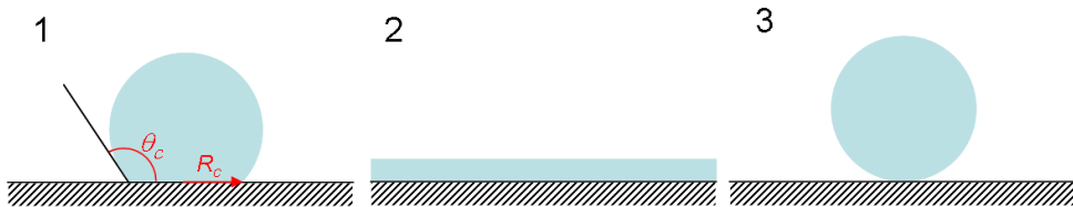
FIG. 1.1: Mouillage d'une goutte liquide sur un substrat solide. 1 mouillage partiel. 2 mouillage total. 3 mouillage nul. R_c est le rayon de contact et \theta_c est l'angle de contact entre le solide et le liquide.
