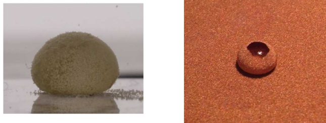
FIG. 6.5: Gauche : goutte enrobée de lycopodes sur une distance comparable. La couverture de la surface par les grains est homogène. Droite : goutte d'eau partiellement recouverte par des billes de cuivre.
