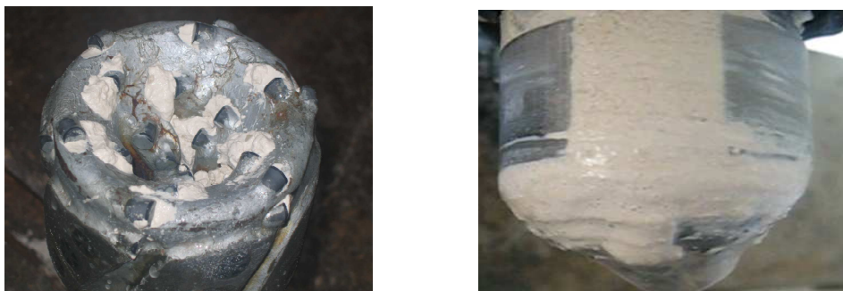
FIG. 1.6 — Trépan en présence d'encrassement
