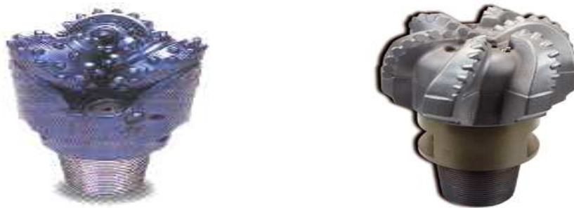
FIG. 1.5 — De gauche à droite trépan tricône et monobloc
