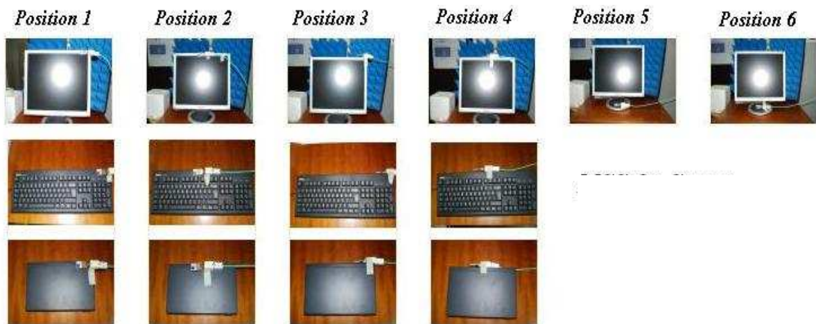
Figure 5-7 Positionnement de l'antenne MSS pour les configurations (Ecran, Clavier, Boîtier).
