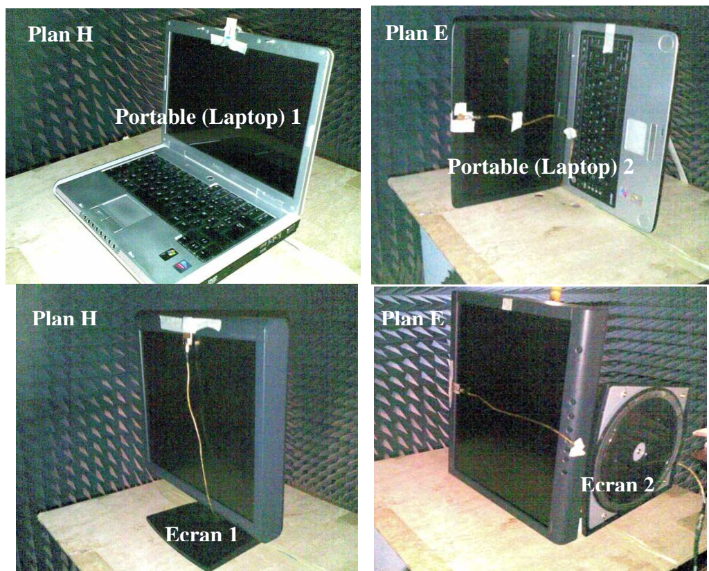
Figure 5-10 Exemples d'antennes ULB montées sur les terminaux perturbateurs
