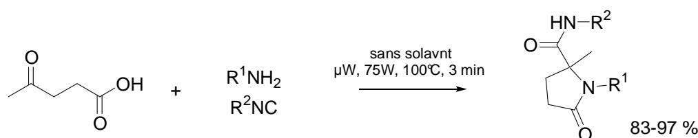
fig. A.40 : Exemple de formation de lactames à 5 chaînons par une U3-CR
