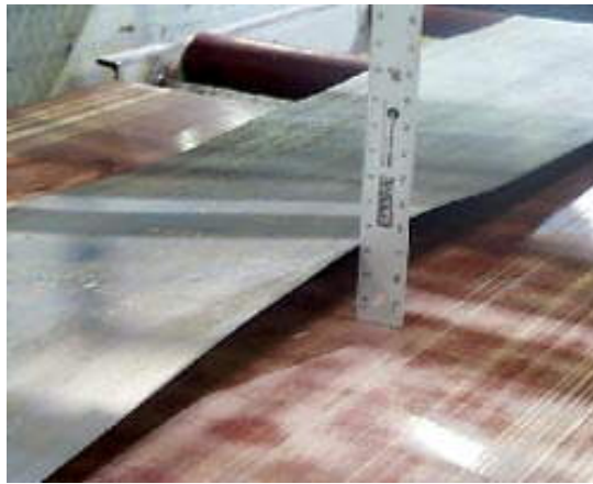
Figure 1-17. Mesure hors ligne et à la règle d'un défaut de planéité manifeste [1].
