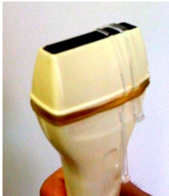
Figure 4.13. Photographie de la sonde échographique avec deux bandes aberrantes en PolyDiMethylSiloxane.
