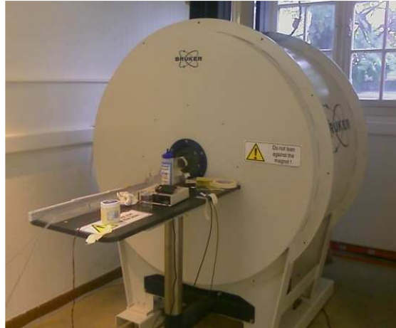
Figure 1.2 Système IRM 7 Teslas disponible à l'ESPCI pour l'imagerie du petit animal (Bruker Pharmascan, Allemagne), équipé de gradients de 300mT/m.
