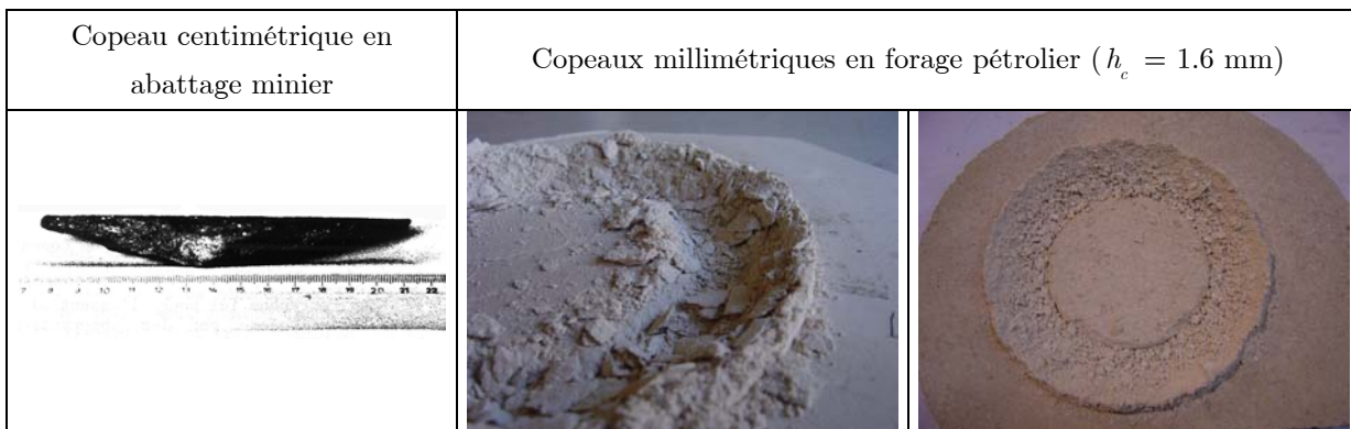
Fig. 3.5 : Débris de coupe à profondeurs de passe élevées (DELIAC, 1986 ; clichés personnels)
