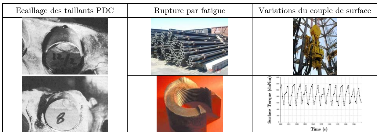
Fig. 1.15 : Effet du stick-slip sur l'intégrité des garnitures de forage
