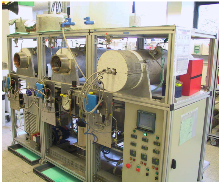
Figure 2.1 – Schéma de principe et photographie des cellules utilisées pour réaliser la prise des pâtes de ciment
