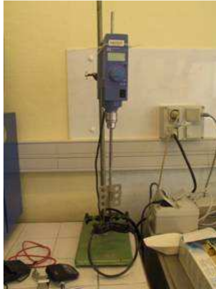
Figure 2 – Agitateur servant à homogénéiser la gâchée de pâte cimentaire
