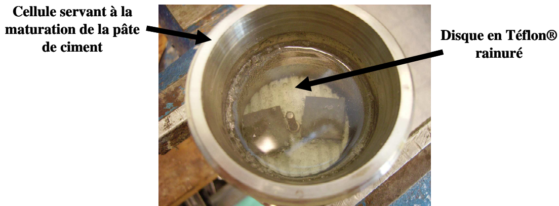
Figure 2.4 – Photographie d'une cellule servant à la maturation des pâtes de ciment (ici pour les échantillons « avec échange ») à 80°C et 70 bar
