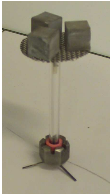
Figure 2.5– Photographie du trépied servant à maintenir les cubes de pâtes de ciment lors des essais de lixiviation à 80°C et pression atmosphérique
