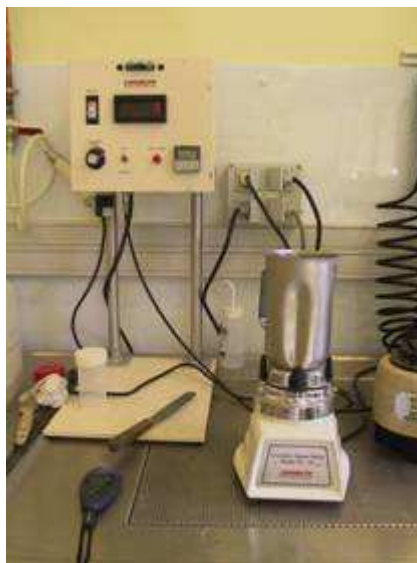
Figure 1 – Mixeur servant à la fabrication des gâchées de pâtes de ciment
