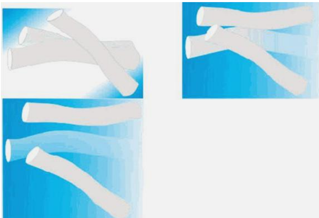
Figure 62: Schématisation du gonflement nanoscopique entre trois agrégats et à l'intérieur d'un paquet de tiges sur une large gamme de teneur en eau, d'une membrane quasi sèche jusqu'à une solution diluée [217]
