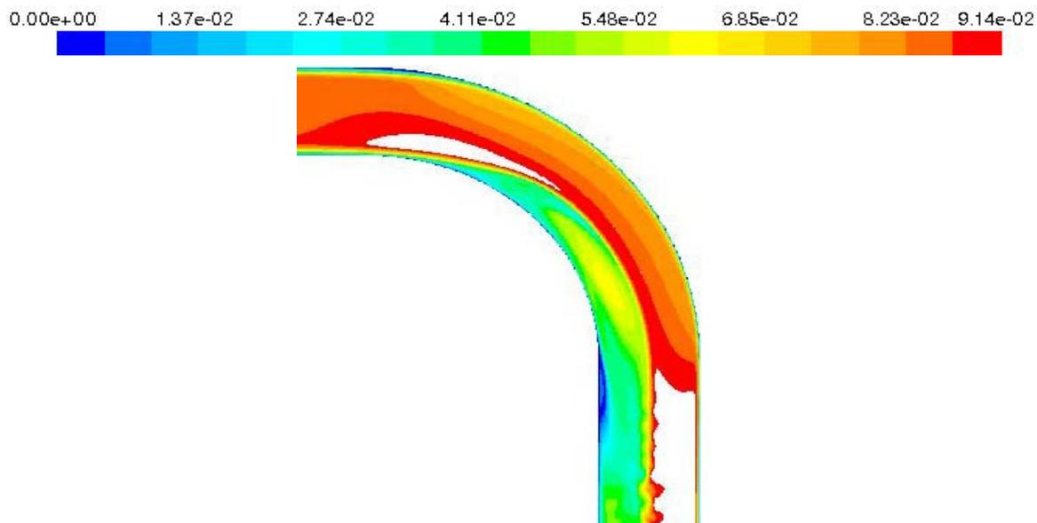
Figure 89 Vitesse modèle RSM avec profil [0 ; 0.0914] m/s
