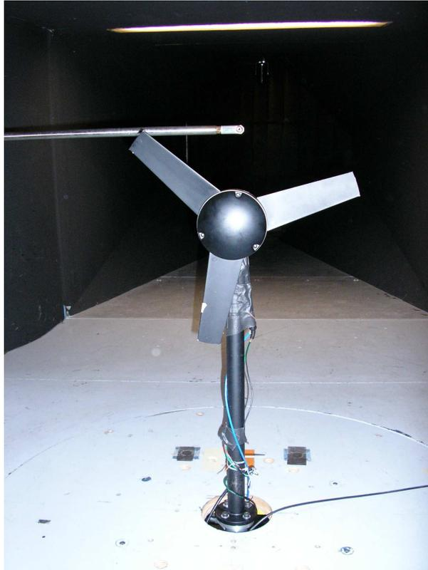
FIGURE 3.3: Maquette éolienne Rutland 503 modifiée
