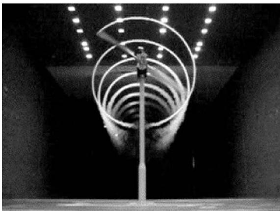
Sillage d'une éolienne testée par le NREL [114]
