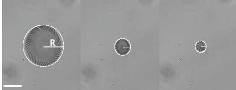
FIGURE 3.30 – Mesure d'amplitude du mouvement : les positions consécutives de l'extrémité libre du filament sont projetées dans le temps.
