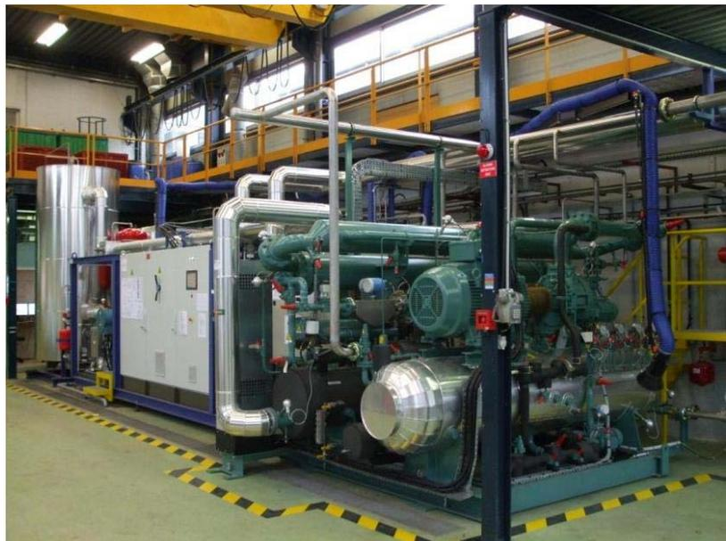
**Figure 2.4 : Photo du simulateur expérimental intégrant la pompe à chaleur dans le laboratoire**
