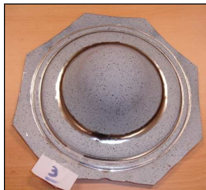
Figure 3.64 : Eprouvette emboutie, résultant d'un essai Nakazima interrompu sur acier Inox 304L.
