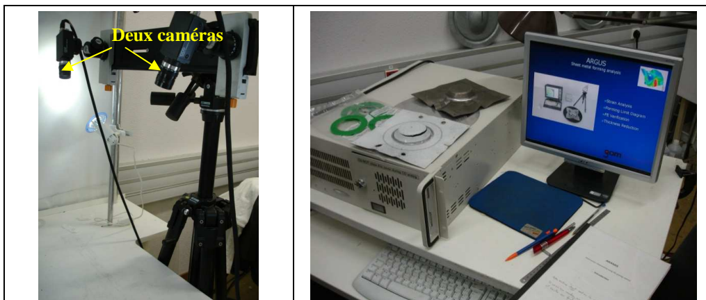
Figure 3.77 : Aperçu du système de stéréocorrélation ARAMIS (CEMEF Sophia Antipolis).
