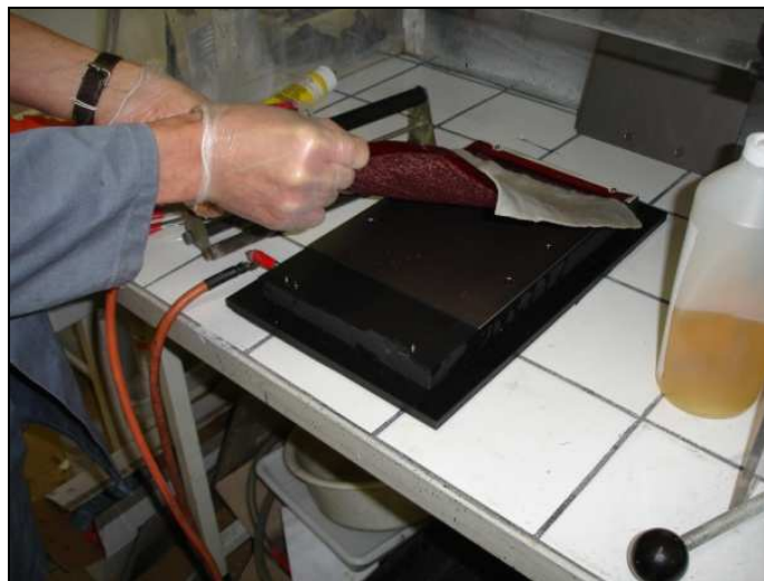
Figure 3.72 : Méthode de gravure électrolytique.
