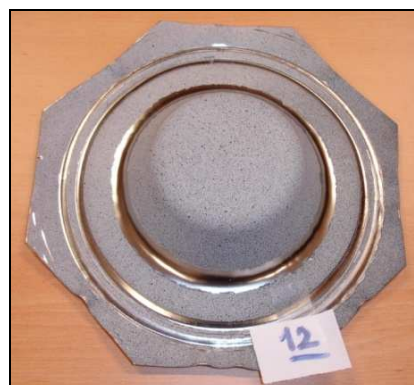
Figure 3.61 : Eprouvette emboutie, résultant d'un essai Marciniak interrompu sur acier Inox 304L.
