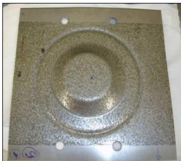
Figure 3.75 : Eprouvette emboutie de l'essai 5.
