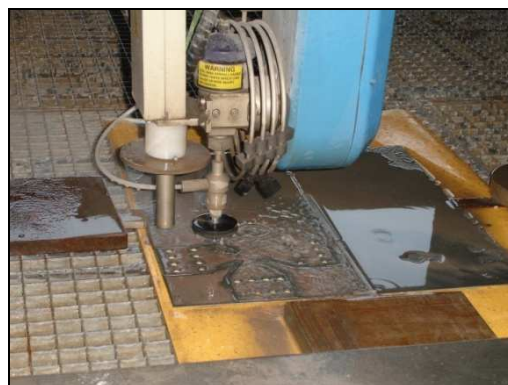
Figure 3.20 : Découpe par jet d'eau des éprouvettes de traction équilibraxiale.
