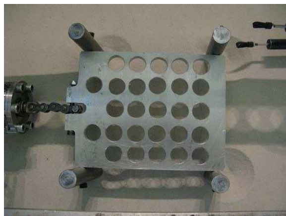
(b) Entretoise utilisée pour un essai à la rupture avec un espacement de e=8B
