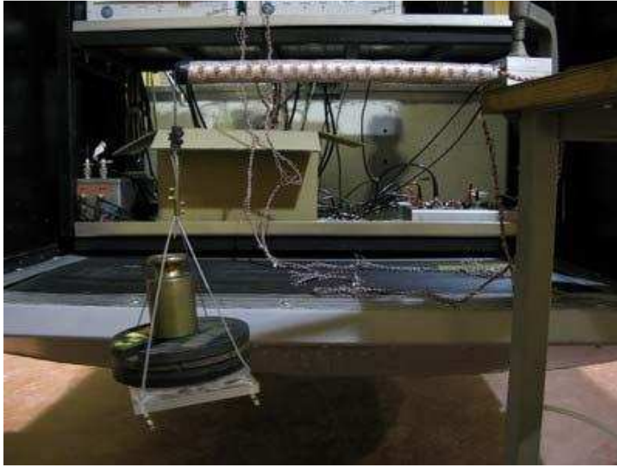
Figure 6 - Dispositif d'étalonnage du pieu
