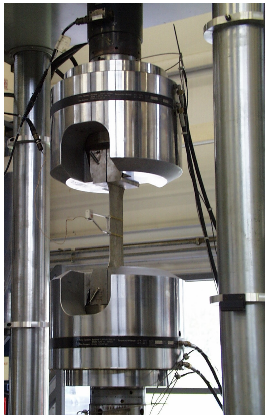
Fig. D.7 – Dispositif de traction sur des éprouvettes de grandes dimensions; Campagne réalisée au laboratoire d'essais mécaniques d'EDF-les Renardières.
