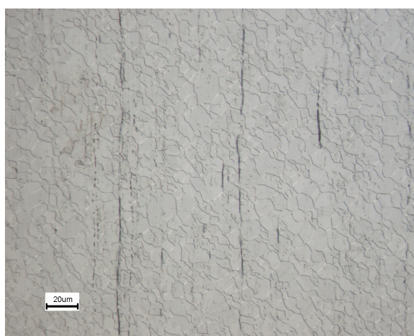
Fig. III.6 – Micrographie le long de l'épaisseur pour l'acier 301 LN : ferrite \delta ségrégée.
