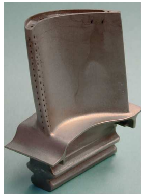
FIG. 1. Aube de turbine haute pression du moteur M88.
