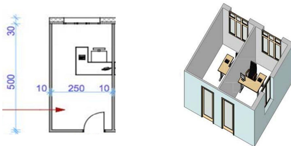
Figure 5-7 : Plan du bureau type 1 et représentation en perspective de deux bureaux adjacents.
