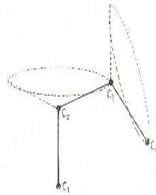
Fig. II.4 – Schématisation des mouvements possibles des liaisons rotules de la chaîne (Treloar, 1949)
