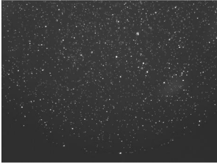
FIGURE 4.1: Observation de particules fluorescentes, de 3 \mu\text{m} de diamètre concentrées à 1% au microscope à fluorescence, avec un objectif 2\times . L'image montre une surface de 3.5 \text{ mm} \times 3.5 \text{ mm} .
