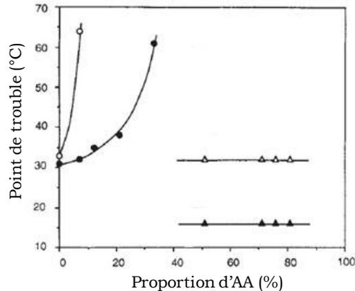
**Figure 21** : Point de trouble de copolymères statistiques à pH 4,0 (●) et 7,4 (○) et de copolymères blocs (greffés) à pH 4,0 (▲) et 7,4 (Δ). D'après Chen et al<sup>60</sup>.
