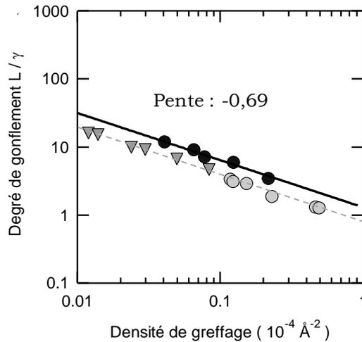
**Figure 15** : Degré de gonflement de brosses de PNIPAM (●) dans l'eau, de PMADAME<sup>6</sup> (●) et P4VP<sup>7</sup> (▼) dans le méthanol en fonction de la densité de greffage.
