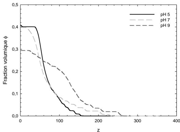
**Figure 3 :** Profils de fraction volumique d'une brosse de PAA ( $M_n = 30\,000\text{ g.mol}^{-1}$  et  $\sigma = 12,5 \cdot 10^{-4}\text{ \AA}^{-2}$ ) dans l'eau lourde à différents pH.
