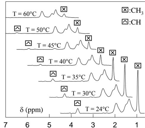
**Figure 4** : Evolution avec la température de spectres RMN  $^1\text{H}$  d'une solution aqueuse à 6 % de PAA-*g*-PNIPAM (0,4 %) dans  $\text{D}_2\text{O}$ . D'après Durand et al<sup>30</sup>.
