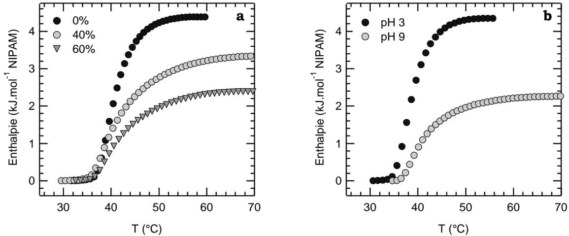
**Figure 34 :** Evolution de l'enthalpie en fonction de la température pour les mélanges PAM-*g*-PNIPAM-*b* / PNIPAM-A10-*b*. **a :** à pH 7, avec différentes proportions massiques de PNIPAM-A10 – **b :** à différents pH, à quantité égale de greffons libres et liés au squelette.
