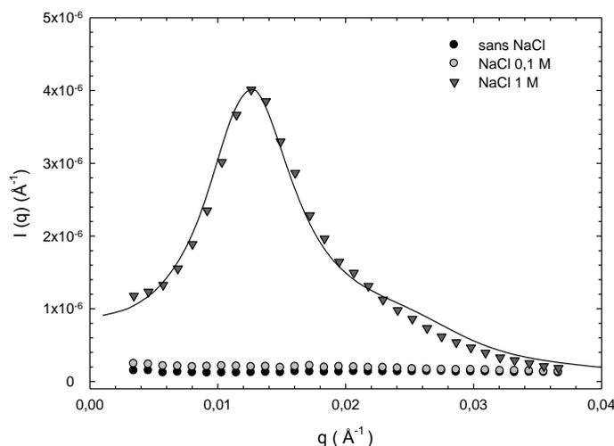
**Figure 32 :** Spectres de diffusion d'une solution de PAM-*g*-PNIPAM-A10-c à 60°C en l'absence et en présence de NaCl (0,1 et 1 M) à pH 7. A chaque courbe expérimentale correspond une courbe calculée (en trait plein).
