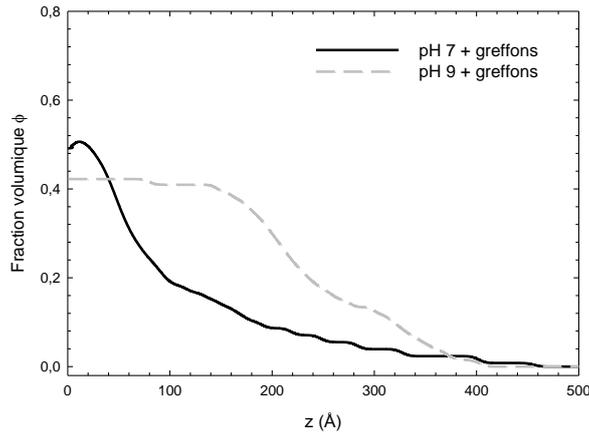
**Figure 9 :** Profils de fraction volumique d'une brosse de PAA ( $M_n = 30\,000\text{ g.mol}^{-1}$  et  $\sigma = 12,5 \cdot 10^{-4}\text{ \AA}^{-2}$ ) dans l'eau lourde en présence de greffons ( $C_p = 1\text{ g.L}^{-1}$ ) et à différents pH.
