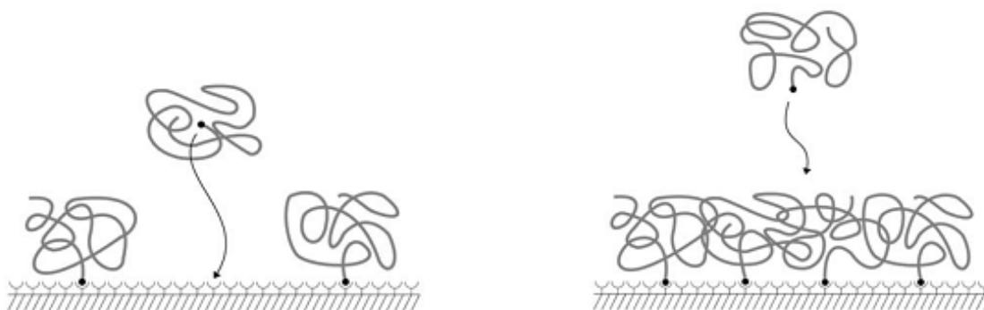
**Figure 3 :** Greffage de chaînes de polymère par « grafting onto ». Cette représentation schématique fait apparaître la diffusion des chaînes vers la surface lorsque des chaînes de polymères sont déjà accrochées.
