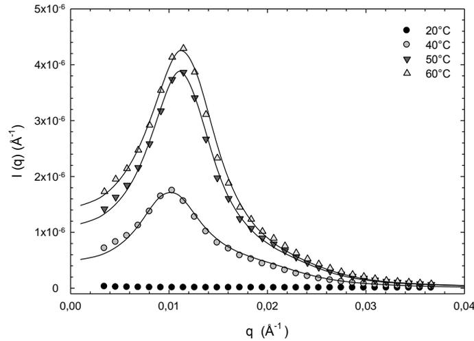
**Figure 12 :** Spectres de diffusion et modélisations d'une solution de PAM-*g*-PNIPAM-*b* ( $C_p = 80 \text{ g.L}^{-1}$ ) à diverses températures.
