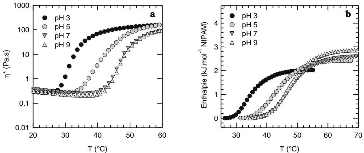
**Figure 40 :** Evolution de la viscosité (a) et de l'enthalpie (b) en fonction de la température pour des mélanges de copolymère PAM-*g*-PNIPAM-A10-*c* ( $C_p = 80 \text{ g.mol}^{-1}$ ) et PNIPAM-M10-*c* (50%) à différents pH.
