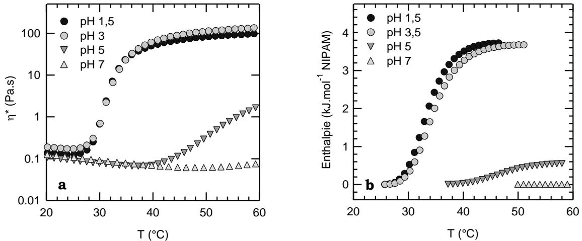
**Figure 25** : Evolution de la viscosité (a) et de l'enthalpie (b) en fonction de la température pour des solutions de copolymère PAM-*g*-PNIPAM-A10-c ( $C_p = 80$  g.mol<sup>-1</sup>) à différents pH.
