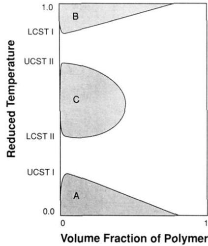
**Figure 12 :** Représentation schématique du comportement thermodynamique des solutions de polymère linéaire. D'après Marchetti et al<sup>36</sup>.
