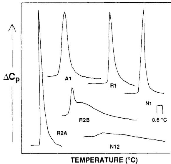
**Figure 2 :** Endothermes de solutions aqueuses de PNIPAM étudiées par DSC à une concentration de 0,4 mg.mL<sup>-1</sup>. Les températures correspondant aux maxima des endothermes sont données dans le tableau 1 et l'échelle de température est reportée sur la figure. D'après Schild et al<sup>7</sup>.
