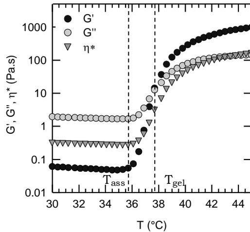
**Figure 7 :** Détermination de la température d'association  $T_{ass}$  et de  $T_{gel}$  à partir de la variation de  $\eta^*$  ( $\nabla$ ),  $G'$  ( $\bullet$ ) et  $G''$  ( $\circ$ ) en fonction de la température ( $C_p = 80 \text{ g.L}^{-1}$ ,  $f = 1 \text{ Hz}$  et  $\sigma = 2 \text{ Pa}$ ).
