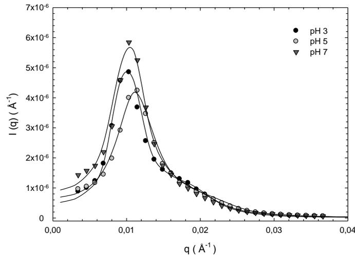
**Figure 42 :** Spectres de diffusion de mélanges PAM-*g*-PNIPAM-A10-*c* et greffons PNIPAM-M10-*c* à différents pH et à 60°C. A chaque courbe expérimentale correspond une courbe calculée (en trait plein).
