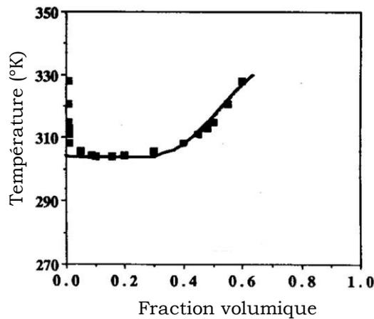
**Figure 14 :** Comparaison entre le diagramme de phase expérimental d'Heskins et al<sup>31</sup> (■) et les prédictions du modèle basé sur les liaisons hydrogène (—). D'après Prange et al<sup>38</sup>.
