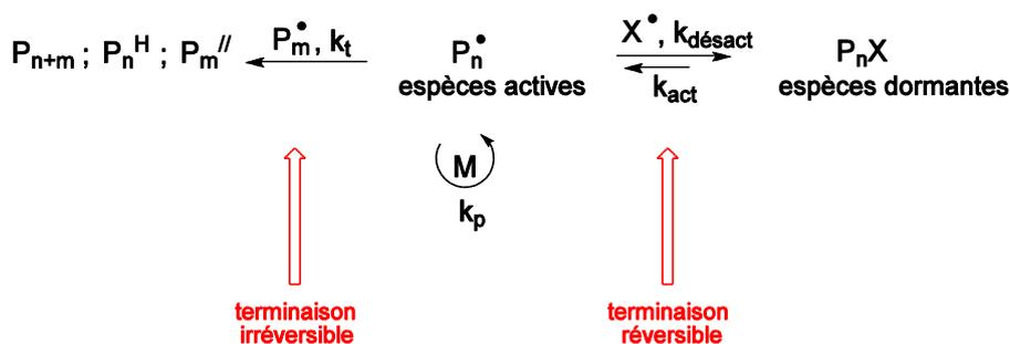
**Figure 12** : Mécanisme de la terminaison réversible.
