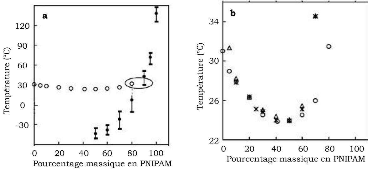
**Figure 6 :** Diagrammes de phase du mélange binaire PNIPAM/eau. **a :** Courbes de démixtion (O) et transition vitreuse de solution de PNIPAM ( $M = 74 \text{ kg/mol}$ ) - **b :** Courbes de démixtion de solutions aqueuses de PNIPAM de masses différentes :  $M = 18 \text{ kg/mol}$  ( $\Delta$ );  $M = 74 \text{ kg/mol}$  (O) et  $M = 187 \text{ kg/mol}$ ). D'après Van Durme et al<sup>34</sup>.
