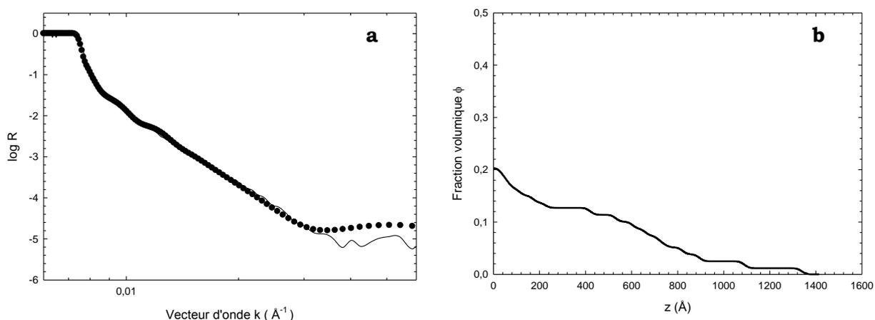
**Figure 11 :** Courbe de réflectivité des neutrons (a) et profil de fraction volumique correspondant (b) d'une brosse de PNIPAM ( $\sigma = 7,76 \cdot 10^{-4} \text{ \AA}^{-2}$  et  $M_n = 121\,000 \text{ g.mol}^{-1}$ ) dans l'eau lourde à température ambiante.
