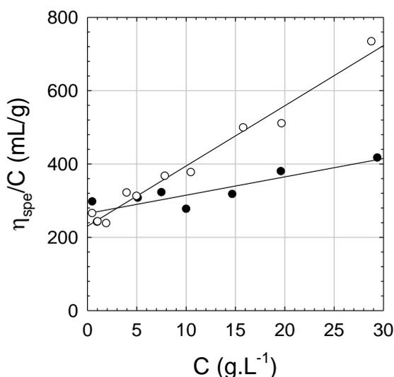
**Figure 3 :** Variation de la viscosité spécifique réduite  $(\eta - \eta_0)/(\eta_0 C)$  à  $T=20^\circ\text{C}$  en fonction de la concentration en PAM-*g*-PNIPAM-A10-b.  $\eta$  et  $\eta_0$  sont respectivement la viscosité de la solution de polymère et celle du solvant. (○) pH = 3 ; (●) pH = 11.
