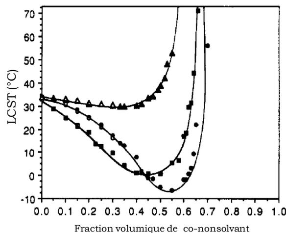
**Figure 25 :** Point de trouble d'une solution de PNIPAM (0.4mg/L) dans des mélanges eau-solvant organique pour trois solvants différents (▲ : méthanol, ■ : THF et ● : dioxane) d'après Schild<sup>1</sup>.
