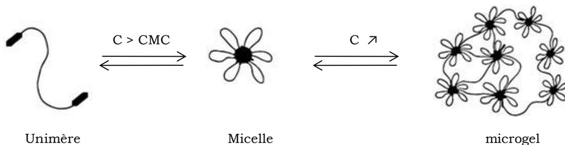
**Figure 23** : Représentation des associations de triblocs ABA. D'après Tam et al<sup>71</sup>.
