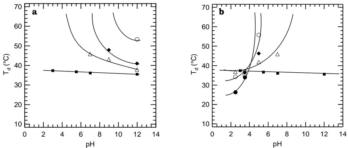
**Figure 15 :** Diagrammes de phase du P(NIPAM<sub>(100-x)</sub>-st-MADAP<sub>x</sub>) (a) et du P(NIPAM<sub>(100-x)</sub>-st-AA<sub>x</sub>) (b).  $x$  représente la proportion d'unités ionisables :  $x = 0$  (■), 5 (Δ), 10 (◆), 20 (○) et 50 (●).
