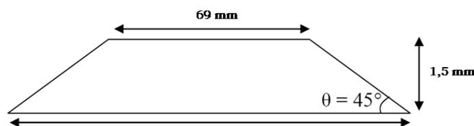
**Figure 1** : Dimensions du cristal ATR de silicium.
