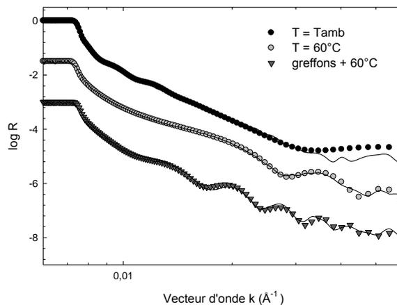
**Figure 24 :** Courbes de réflectivité des neutrons d'une brosse de PNIPAM ( $M_n = 121\,000\text{ g.mol}^{-1}$  et  $\sigma = 7,76 \cdot 10^{-4}\text{ \AA}^{-2}$ ) dans l'eau lourde à température ambiante, à 60°C et en présence de greffons à pH 7 à 60°C. A chaque courbe expérimentale correspond une courbe calculée (en trait plein). Les courbes sont décalées pour une meilleure visibilité.
