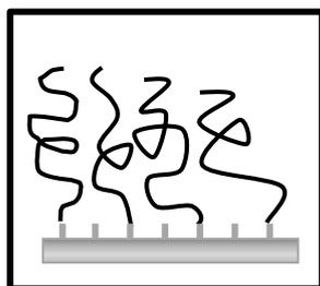
**Figure 1** : Représentation schématique des brosses de polymère.
