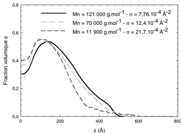
**Figure 28 :** Profils de fraction volumique de brosses de PNIPAM de différentes masses molaires ( $M_n = 121\,000$ ,  $70\,000$  et  $11\,900$  g.mol<sup>-1</sup>) en présence de greffons PNIPAM-A10-b ( $C_p = 0,1\%$ ) à pH 7 et à 60°C.
