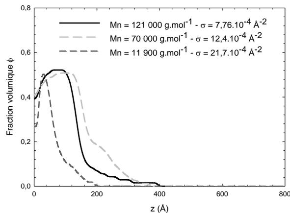
**Figure 20 :** Profils de fraction volumique de brosses de PNIPAM de longueurs de chaînes différentes (Mn = 121 000, 70 000 et 11 900 g.mol<sup>-1</sup>) dans l'eau lourde à pH 7 et à 60°C.
