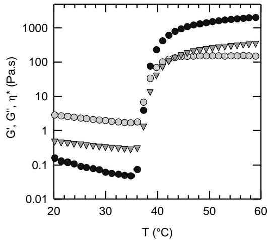
**Figure 4 :** Evolution en fonction de la température des modules élastique  $G'$  (●) et visqueux  $G''$  (○) ainsi que de la viscosité complexe  $\eta^*$  (▼) pour une solution de copolymère PAM-g-PNIPAM-b ( $C_p = 80 \text{ g.L}^{-1}$ ,  $f = 1 \text{ Hz}$  et  $\sigma = 2 \text{ Pa}$ ).
