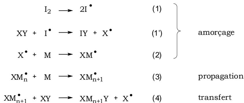
**Figure 4** : Mécanisme de la télomérisation.
