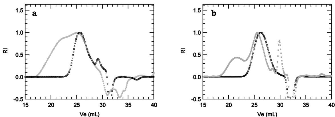
**Figure 6 :** Chromatogrammes de la cotéomérisation des systèmes NIPAM/MADAP (a) et NIPAM/AA (b) à  $t = 3,5$  h, à pH acide (■) et basique (▣).
