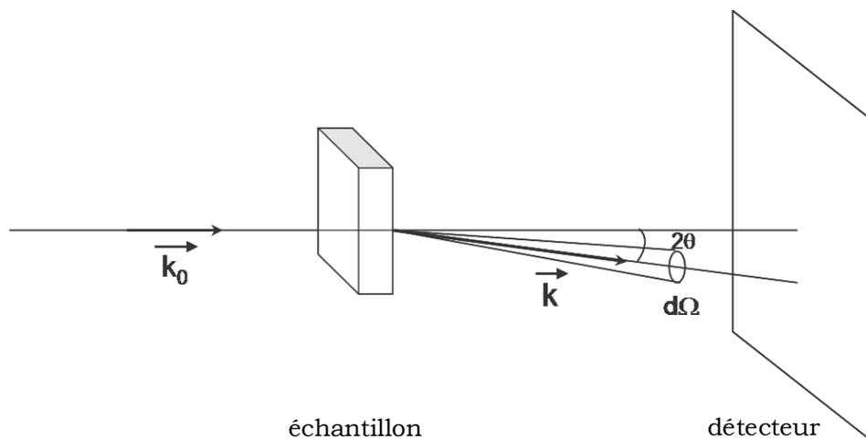
Schéma de principe d'une expérience de diffusion
