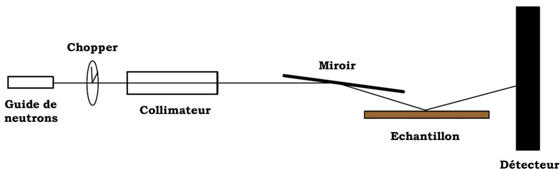
**Figure 8** : Schéma du montage de réflectivité des neutrons.
