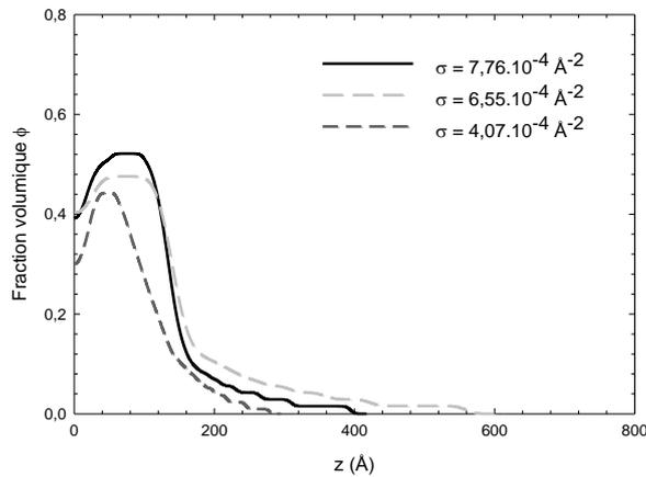
**Figure 19 :** Profils de fraction volumique de brosses de PNIPAM de masse  $M_n = 121\,000\text{ g.mol}^{-1}$  de densités de greffage  $\sigma = 7,76.10^{-4}\text{ \AA}^{-2}$ ,  $\sigma = 6,55.10^{-4}\text{ \AA}^{-2}$  et  $\sigma = 4,07.10^{-4}\text{ \AA}^{-2}$  dans l'eau lourde à 60°C.
