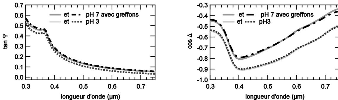
**Figure 6 :** Mesures spectroscopiques de  $\tan \psi$  et  $\cos \Delta$ . Les traits pleins représentent les mesures du 1<sup>er</sup> cycle, les pointillés celles du 2<sup>ème</sup> cycle.
