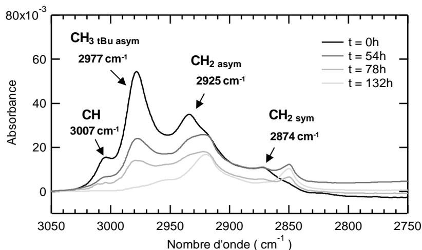
**Figure 10** : Spectres IR-ATR de la brosse de P<sup>t</sup>BuA lors de l'hydrolyse.
