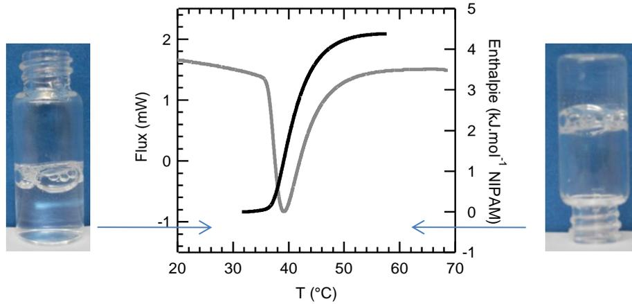
**Figure 8 :** Thermogramme et courbe intégrale enthalpique d'une solution de PAM-*g*-PNIPAM-*b* à 80 g.L<sup>-1</sup>.
