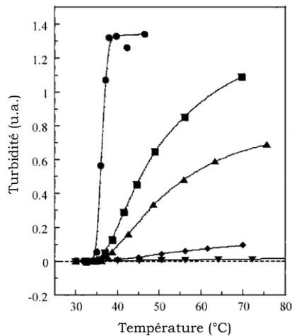
**Figure 18 :** Influence de la température sur la turbidité de solution aqueuse à  $10 \text{ g.mL}^{-1}$  de  $\text{P}(\text{NIPAM}_{95}\text{-MADAP}_5)$  dans différents état d'ionisation. Le taux d'ionisation est variable : 0 (●), 0,0125 (■), 0,025 (▲), 0,035 (◆) et 0,05 (▼). D'après Bokias et al<sup>55</sup>.
