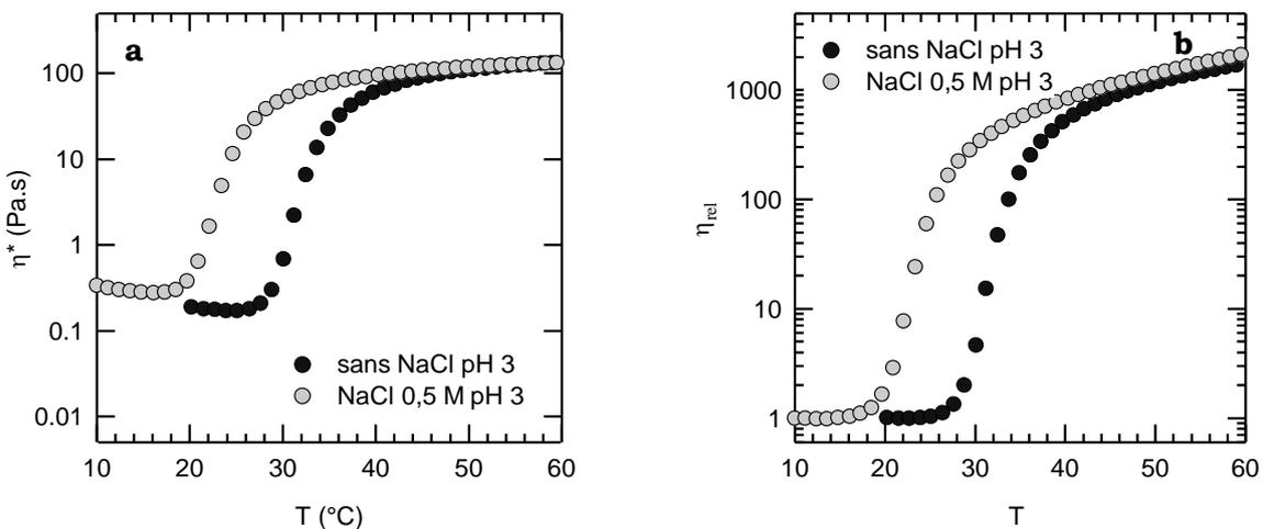
**Figure 27 :** Evolution de la viscosité (a) et de la viscosité relative (b) en fonction de la température pour PAM-*g*-PNIPAM-A10-c ( $C_p = 80 \text{ g.L}^{-1}$ ) sans sel et en présence de NaCl  $0,5 \text{ M}$  à pH 3.
