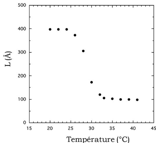
**Figure 18** : Evolution de l'épaisseur gonflée en fonction de la température lors d'un refroidissement à partir de  $41^\circ\text{C}$ , d'après Yim et al<sup>8</sup>.
