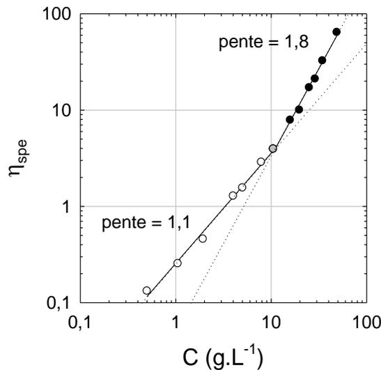
**Figure 2 :** Evolution de la viscosité avec la concentration en copolymère PAM-*g*-PNIPAM-A10-b à pH 3 et  $T=20^\circ\text{C}$  : (○) régime dilué, (◐)  $C^*$  et (●) régime semi-dilué.
