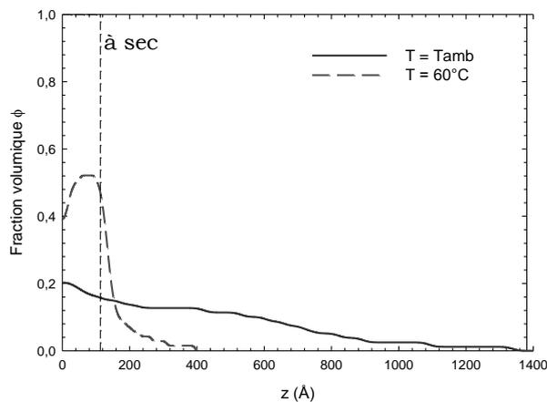
**Figure 17 :** Profils de fraction volumique d'une brosse de PNIPAM ( $M_n = 121\,000\text{ g.mol}^{-1}$  et  $\sigma = 7,76.10^{-4}\text{ \AA}^{-2}$ ) dans l'eau lourde à température ambiante et à  $60^\circ\text{C}$ .
