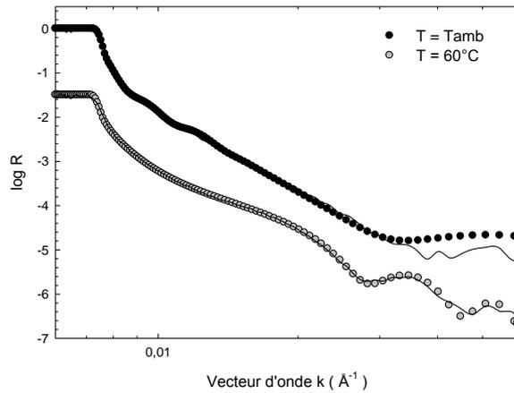
**Figure 16 :** Courbes de réflectivité de neutrons d'une brosse de PNIPAM ( $M_n = 121\,000\text{ g.mol}^{-1}$  et  $\sigma = 7,76.10^{-4}\text{ \AA}^{-2}$ ) dans l'eau lourde à température ambiante et à  $60^\circ\text{C}$ . A chaque courbe expérimentale correspond une courbe calculée (en trait plein). Les courbes sont décalées pour une meilleure visibilité.
