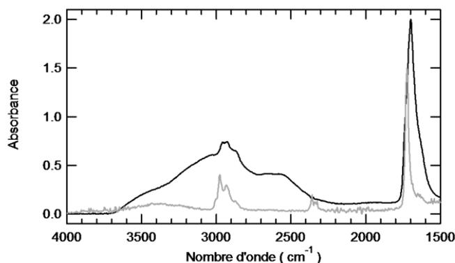
**Figure 9** : Spectres IR-ATR des homopolymères P<sup>t</sup>BuA (noir) et PAA (gris).
