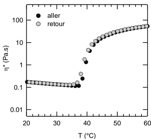
**Figure 13** : Evolution de la viscosité complexe en fonction de la température lors d'un cycle chauffage/refroidissement pour une solution de PAM-*g*-PNIPAM-a à C<sub>p</sub> = 20 g.L<sup>-1</sup>.
