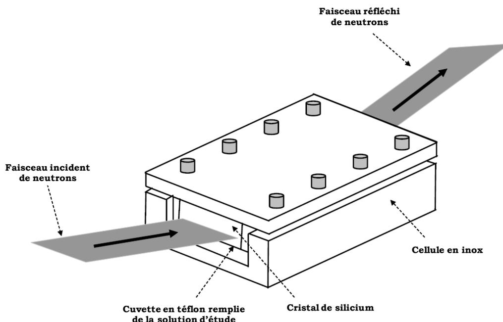
**Figure 10** : Schéma de la cellule externe en inox qui maintient en contact une cuvette en téflon remplie de la solution d'étude et le cristal de silicium (dimensions :  $100 \times 50 \times 10$  mm<sup>3</sup>) dont la surface est couverte d'une brosse de polymère.
