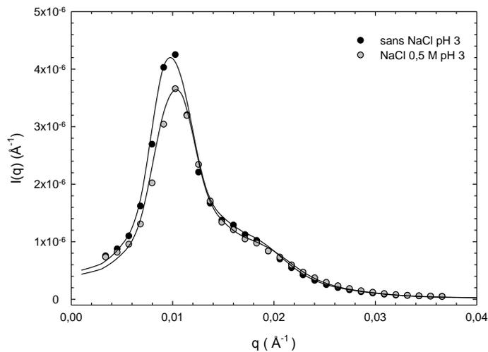
**Figure 29 :** Spectres de diffusion d'une solution de PAM-*g*-PNIPAM-A10-c à 60°C en l'absence et en présence de NaCl (0,5 M) à pH 3. A chaque courbe expérimentale correspond une courbe calculée (en trait plein).
