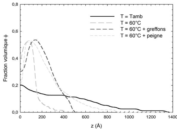
**Figure 29 :** Profils de fraction volumique d'une brosse de PNIPAM ( $M_n = 121\ 000\ \text{g.mol}^{-1}$  et  $\sigma = 7,76 \cdot 10^{-4}\ \text{\AA}^{-2}$ ) à température ambiante, à  $60^\circ\text{C}$ , en présence de greffons PNIPAM-M10-b ( $C_p = 0,1\ \%$ ) et de copolymère en peigne ( $C_p = 0,5\ \%$ ) à pH 7 et  $60^\circ\text{C}$ .
