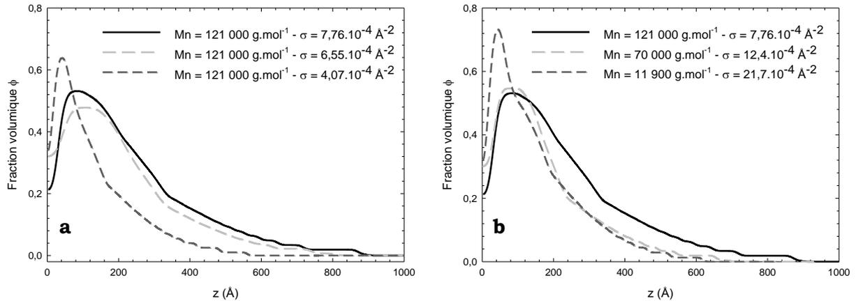
**Figure 30 :** Profils de fraction volumique d'une brosse de PNIPAM en présence de copolymère en peigne ( $C_p = 0,5 \%$ ) à  $60^\circ\text{C}$ . **a** : influence de la densité de greffage pour une masse de  $121\,000\text{ g.mol}^{-1}$ - **b** : influence de la masse molaire des chaînes greffées.
