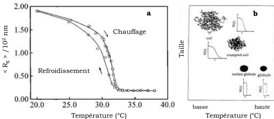
**Figure 1** : **a** : Evolution du rayon de giration moyen  $\langle R_g \rangle$  des chaînes de PNIPAM dans l'eau en fonction de la température, lors d'une élévation et d'une baisse de température, **b** : Représentation schématique des états thermodynamiquement stables observés lors de la transition pelote-globule et leurs distributions de densité de chaînes respectives. D'après Wang et al<sup>17</sup>.
