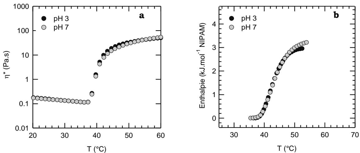
**Figure 15 :** Evolution de la viscosité complexe (a) et de l'enthalpie (b) en fonction de la température pour des solutions de copolymère PAM-*g*-PNIPAM-a ( $C_p = 20 \text{ g.mol}^{-1}$ ) à différents pH.
