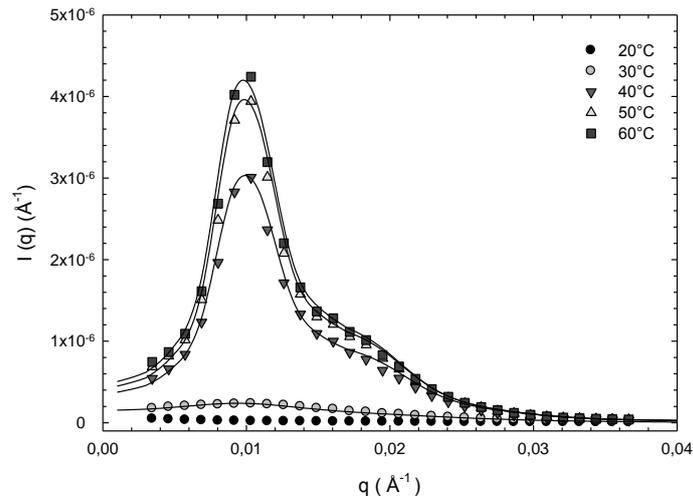
**Figure 19 :** Spectres de diffusion d'une solution de PAM-*g*-PNIPAM-A10-c à pH 3 et à différentes températures. A chaque courbe expérimentale correspond une courbe calculée (en trait plein).
