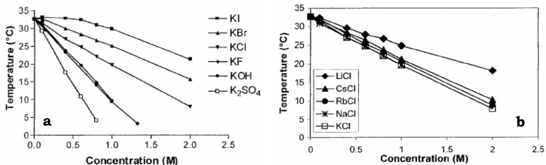
**Figure 24 :** Température de point de trouble d'une solution de PNIPAM ( $C_p = 1\%$ ) en fonction de la concentration en sels de potassium (a) et en chlorure alcalino-terreux (b) ajoutés. D'après Freitag et al<sup>83</sup>.
