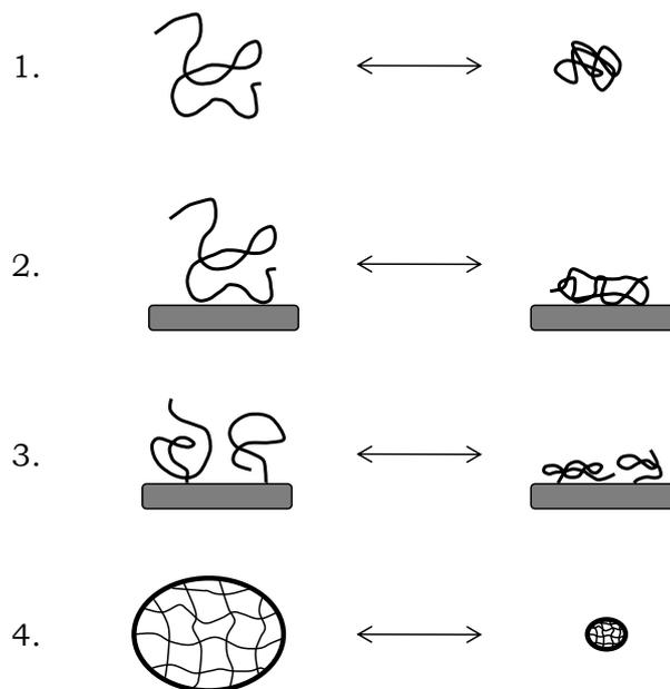
**Figure 27 :** Comportement de chaînes de PNIPAM dans différentes géométries. D'après Hoffman et al<sup>87</sup>.
