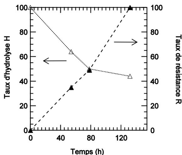
**Figure 11 :** Evolution du taux d'hydrolyse H et du taux de résistance R de la brosse de P<sup>t</sup>BuA en fonction du temps d'hydrolyse.
