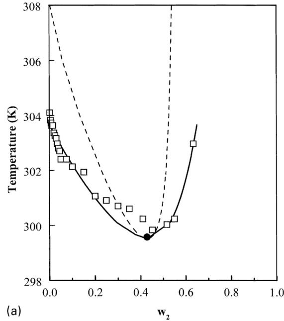
**Figure 11** : Comparaison entre le diagramme de phase expérimental (□) et les prédictions du modèle appliquées aux solutions aqueuses de PNIPAM ( $M_n = 83$  kg/mol) : binodale (—), spinodale (- - -) et point critique (●). D'après Afroze et al<sup>32</sup>.
