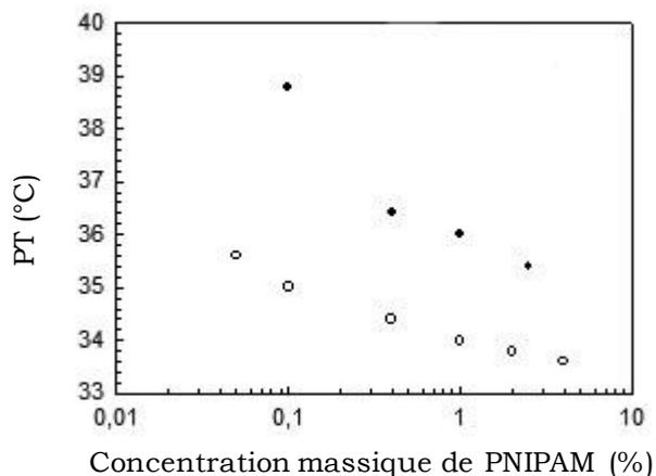
**Figure 16 :** Diagramme de phases du PNIPAM ( $M_n = 5\ 000$  (●) et  $10\ 000$  (○) g.mol<sup>-1</sup>) dans l'eau. D'après Durand<sup>47</sup>.
