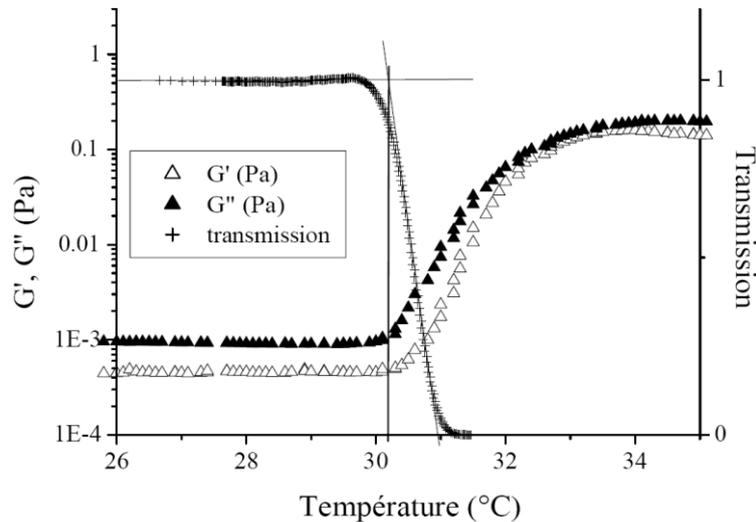
**Figure 3** : Mesures de transmission et de rhéologie sur un échantillon de PNIPAM ( $C_p = 1\%$ ) à des rampes de 0,013 ( $\Delta$  et  $\blacktriangle$ ) et 0,1°C/min ( $+$ ). D'après C. Balu<sup>29</sup>.
