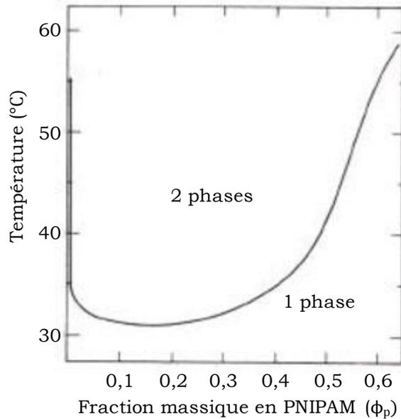
**Figure 5** : Diagramme de phase du binaire PNIPAM / eau. D'après Heskins et al<sup>31</sup>.
