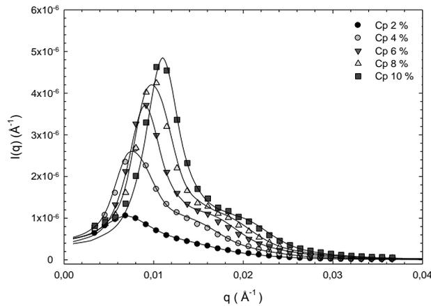
**Figure 21 :** Spectres de diffusion d'une solution de PAM-*g*-PNIPAM-A10-c à différentes concentrations en copolymère à 60°C. A chaque courbe expérimentale correspond une courbe calculée (en trait plein).
