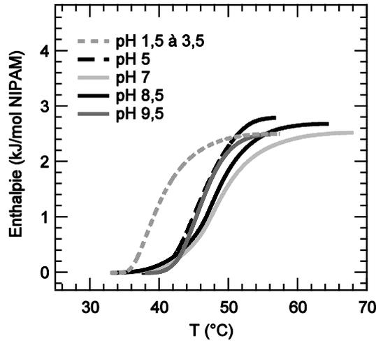
**Figure 16 :** Courbes intégrales relatives au mélange de P(NIPAM<sub>90</sub>-*st*-MADAP<sub>10</sub>) et P(NIPAM<sub>90</sub>-*st*-AA<sub>10</sub>) à différents pH.
