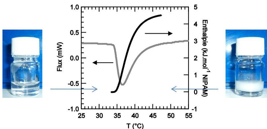
**Figure 10 :** Thermogramme et courbe intégrale enthalpique d'une solution de PNIPAM à  $10 \text{ g.L}^{-1}$ .
