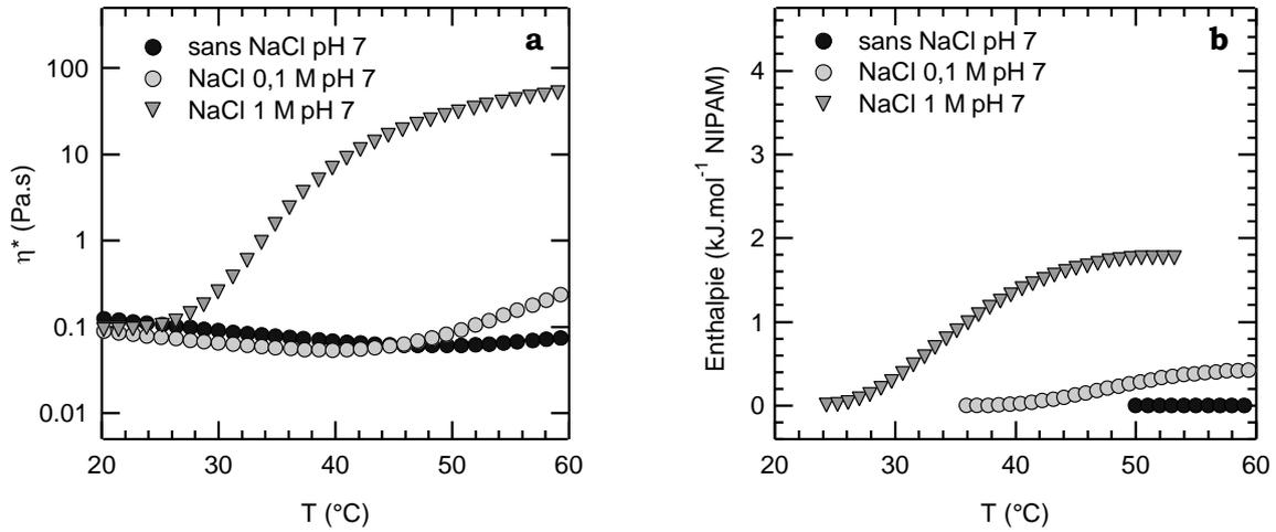
**Figure 30 :** Evolution de la viscosité (a) et de l'enthalpie (b) en fonction de la température pour PAM-*g*-PNIPAM-A10-c ( $C_p = 80 \text{ g.L}^{-1}$ ) sans sel et en présence de NaCl à 0,1 et 1 M à pH 7.
