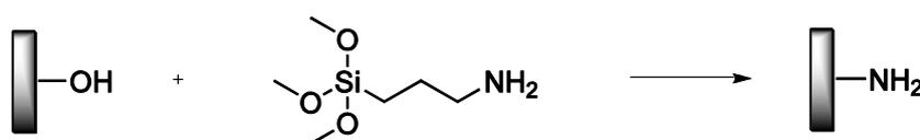
**Figure 22 :** Formation d'une monocouche auto-assemblée d'amine.
