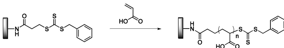
**Figure 25** : Polymérisation RAFT de l'acide acrylique.**Mode opératoire**
