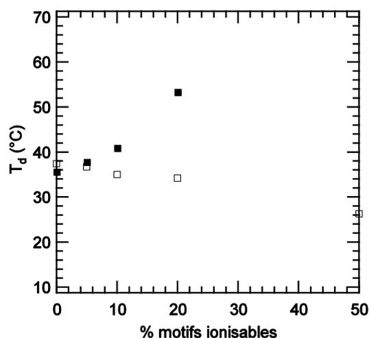
**Figure 13 :** Variation de la température d'association avec le taux de motifs ionisables pour les copolymères P(NIPAM<sub>(100-x)</sub>-*st*-MADAP<sub>x</sub>) à pH 12 (■) et P(NIPAM<sub>(100-x)</sub>-*st*-AA<sub>x</sub>) à pH 3,5 (□).
