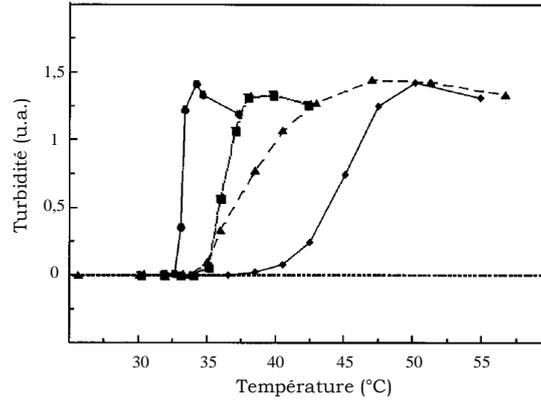
**Figure 17 :** Influence de la température sur la turbidité de solutions aqueuses à  $10 \text{ g.mL}^{-1}$  de  $\text{P}(\text{NIPAM}_{(1-x)}\text{-MADAP}_x)$  sous forme basique.  $x = 0$  (●), 5 (■), 10 (▲) et 25 % molaire (◆). D'après Bokias et al<sup>55</sup>.
