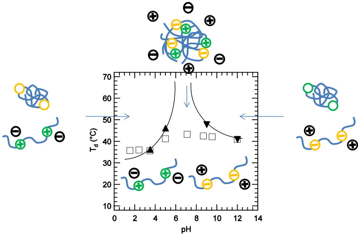
**Figure 17 :** Diagramme de phase du P(NIPAM<sub>90</sub>-*st*-MADAP<sub>10</sub>) (▼), P(NIPAM<sub>90</sub>-*st*-AA<sub>10</sub>) (▲) et du mélange de P(NIPAM<sub>90</sub>-*st*-MADAP<sub>10</sub>) et P(NIPAM<sub>90</sub>-*st*-AA<sub>10</sub>) (□).
