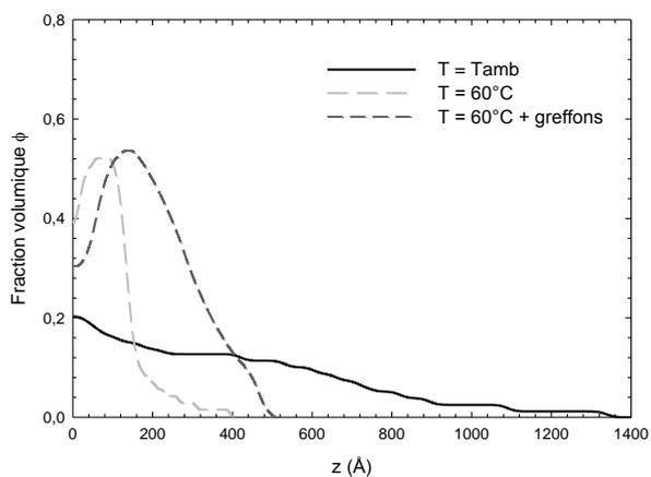
**Figure 25 :** Profils de fraction volumique d'une brosse de PNIPAM ( $M_n = 121\,000\text{ g.mol}^{-1}$  et  $\sigma = 7,76 \cdot 10^{-4}\text{ \AA}^{-2}$ ) à température ambiante, à  $60^\circ\text{C}$  et en présence de greffons PNIPAM-A10-b ( $C_p = 0,1\%$ ) à  $60^\circ\text{C}$ .
