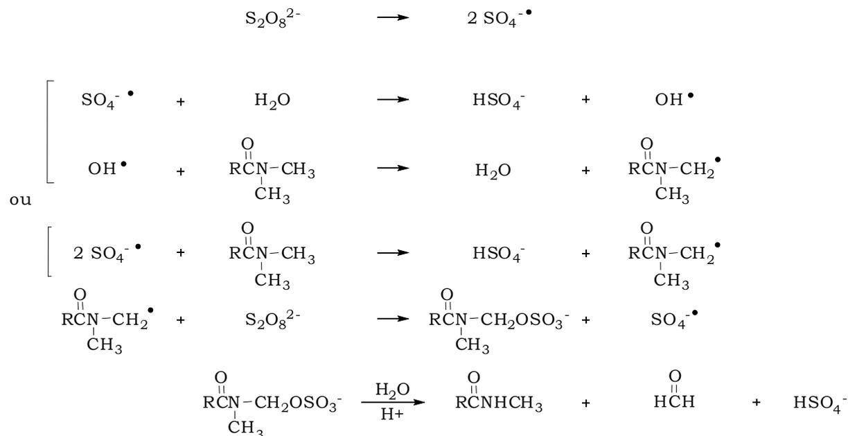
**Figure 7** : Réactions secondaires entre des amides N et N,N-substitués et le persulfate de potassium dans l'eau<sup>15</sup>.
