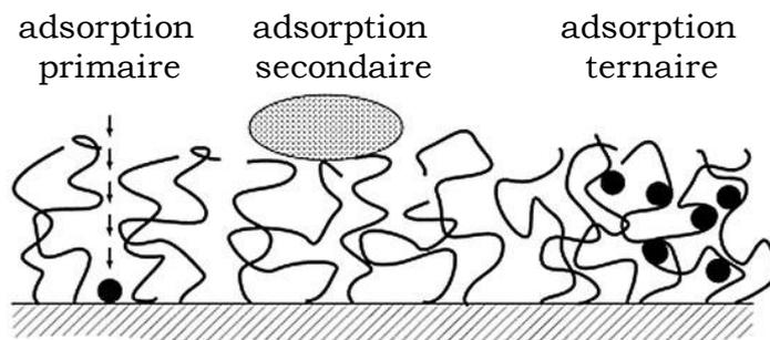
**Figure 31** : Différents mécanismes d'adsorption sur des brosses de polymère, d'après<sup>35</sup>.
