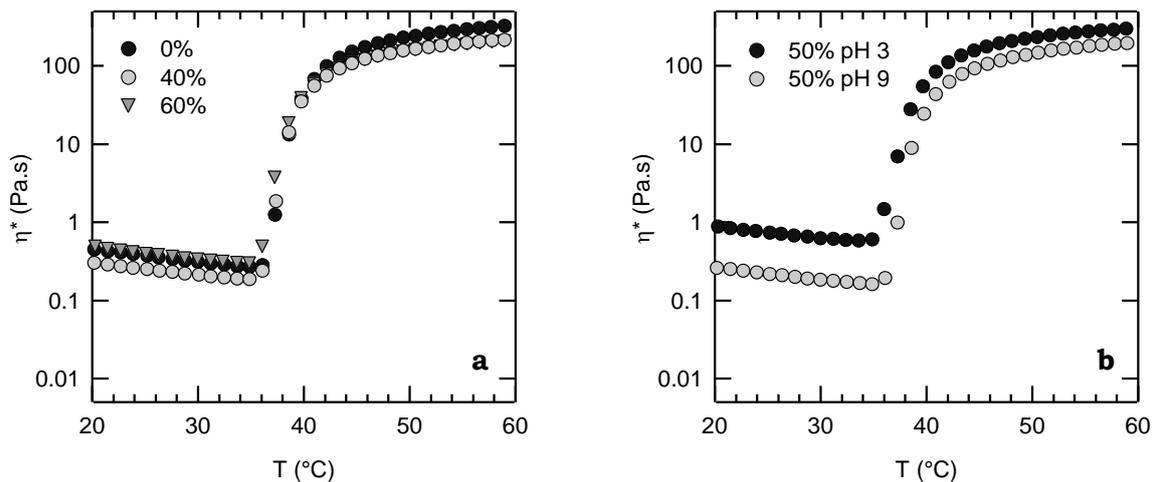
**Figure 33 :** Evolution de la viscosité en fonction de la température pour les mélanges PAM-*g*-PNIPAM-*b* / PNIPAM-A10-*b*. **a** : à pH 7, avec différentes proportions massiques de PNIPAM-A10 – **b** : à différents pH, à quantité égale de greffons libres et liés au squelette.
