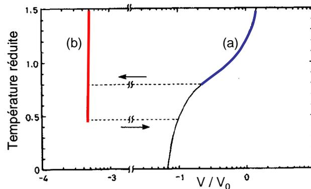
**Figure 15 :** Variation du volume du gel ( $V$ ) par rapport à son volume de référence ( $V_0$ ) en fonction de la température réduite ( $T/\Theta$ ) : (a) en absence et (b) en présence d'interactions hydrophobes. D'après Otake et al<sup>39</sup>.
