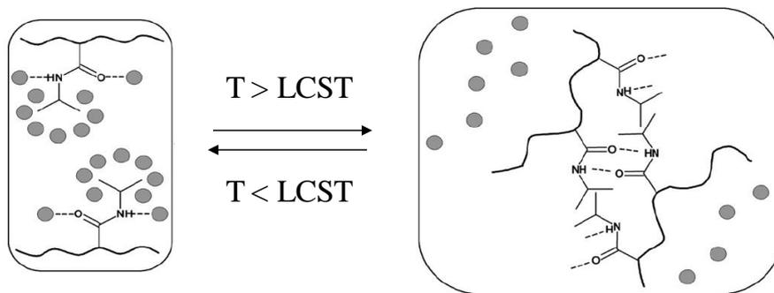
**Figure 9 :** Représentation schématique de la transition de phase du PNIPAM. D'après Dimitrov et al<sup>4</sup>.
