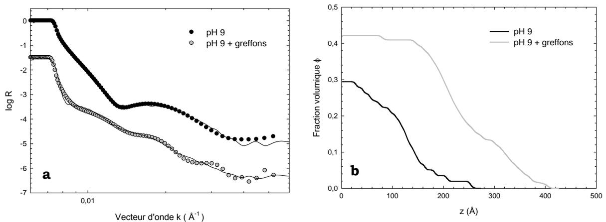
**Figure 8** : Courbes de réflectivité de neutrons (a) et profils de fraction volumique correspondants (b) d'une brosse de PAA ( $M_n = 30\,000$  g.mol<sup>-1</sup> et  $\sigma = 12,5 \cdot 10^{-4}$  Å<sup>-2</sup>) dans l'eau
