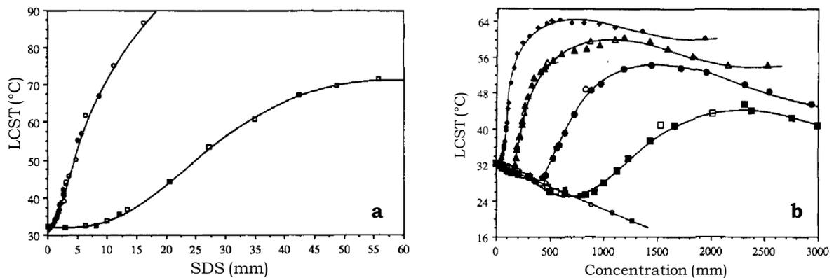
**Figure 26 :** Evolution de la LCST d'une solution de PNIPAM ( $0,4 \text{ mg.L}^{-1}$ ) en fonction de la concentration de SDS ( $\bullet$ ) et n-décylsulfate de sodium ( $\blacksquare$ ) (a) et de n-alkylsulfates de sodium (b) avec  $n = 4$  ( $\circ$ ), 5 ( $\blacksquare$ ), 6 ( $\bullet$ ), 7 ( $\blacktriangle$ ) et 8 ( $\blacklozenge$ ). D'après Schild et al<sup>86</sup>.
