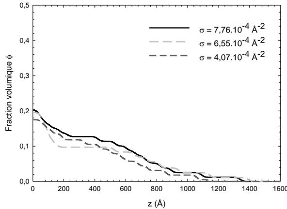
**Figure 11 :** Profils de fraction volumique de brosses de PNIPAM ( $M_n = 121\ 000\ \text{g.mol}^{-1}$ ) de densités de greffage  $\sigma = 7,76.10^{-4}$ ,  $6,55.10^{-4}$  et  $4,07.10^{-4}\ \text{\AA}^{-2}$  dans l'eau lourde à température ambiante.
