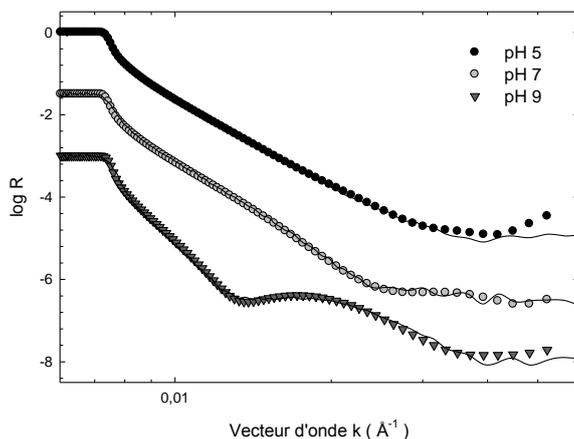
**Figure 2 :** Courbes de réflectivité de neutrons d'une brosse de PAA ( $M_n = 30\,000\text{ g.mol}^{-1}$  et  $\sigma = 12,5 \cdot 10^{-4}\text{ \AA}^{-2}$ ) dans l'eau lourde à différents pH. A chaque courbe expérimentale, correspond une courbe calculée (en trait plein). Les courbes sont décalées pour une meilleure visibilité.
