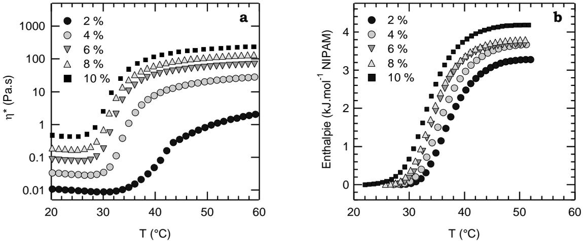
**Figure 20 :** Evolution en fonction de la température de la viscosité (a) et de l'enthalpie (b) pour des solutions de copolymère PAM-*g*-PNIPAM-A10-c à différentes concentrations et à pH 3.
