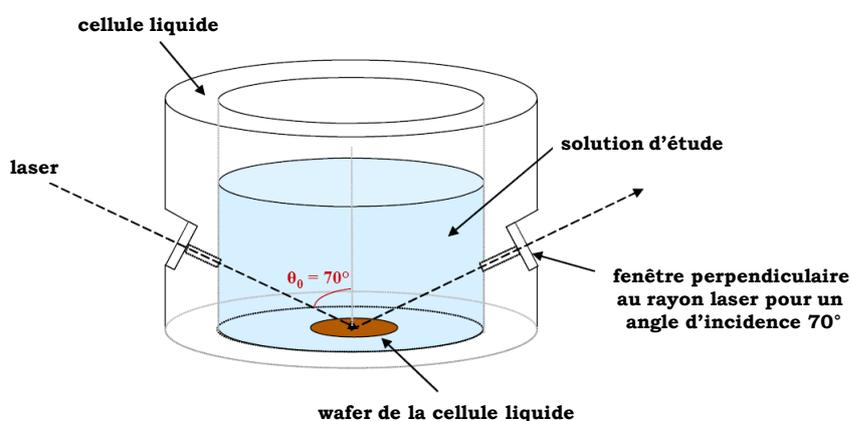
**Figure 6** : Schéma de la cellule liquide.
