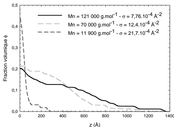
**Figure 12 :** Profils de fraction volumique de brosses de PNIPAM de longueurs de chaînes différentes ( $M_n = 121\,000$ ,  $70\,000$  et  $11\,900$  g.mol<sup>-1</sup>) dans l'eau lourde et à température ambiante.
