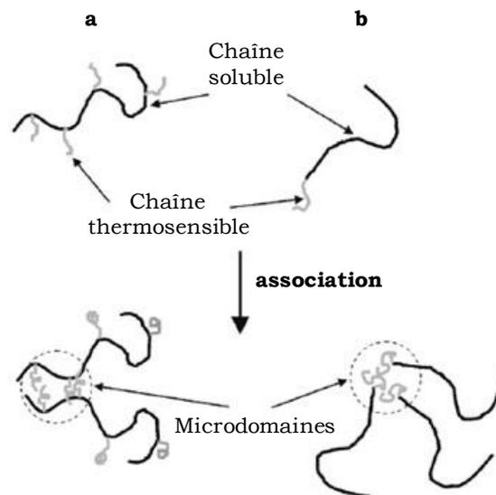
**Figure 22** : Représentation schématique du processus associatif en solution aqueuse - **a** : pour un copolymère en peigne - **b** : d'un copolymère bloc. D'après Dimitrov et al<sup>4</sup>.
