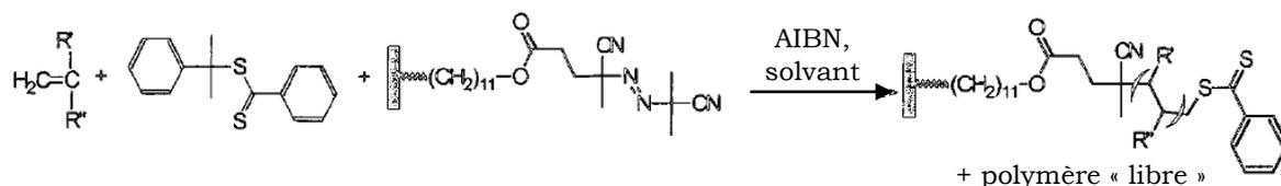
**Figure 16** : Synthèse d'une brosse de polymère par procédé RAFT lorsque l'amorceur est fixé sur la surface<sup>24</sup>.
