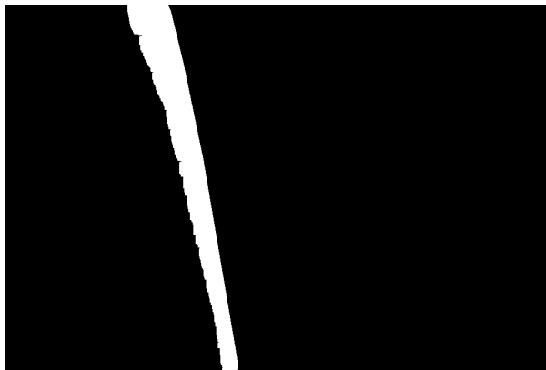
Figure Annexe.10.a) Image binarisée de manière à pouvoir réaliser les mesures d'épaisseurs de couche resolidifiée, b) histogramme lissé par une courbe de Bézier
