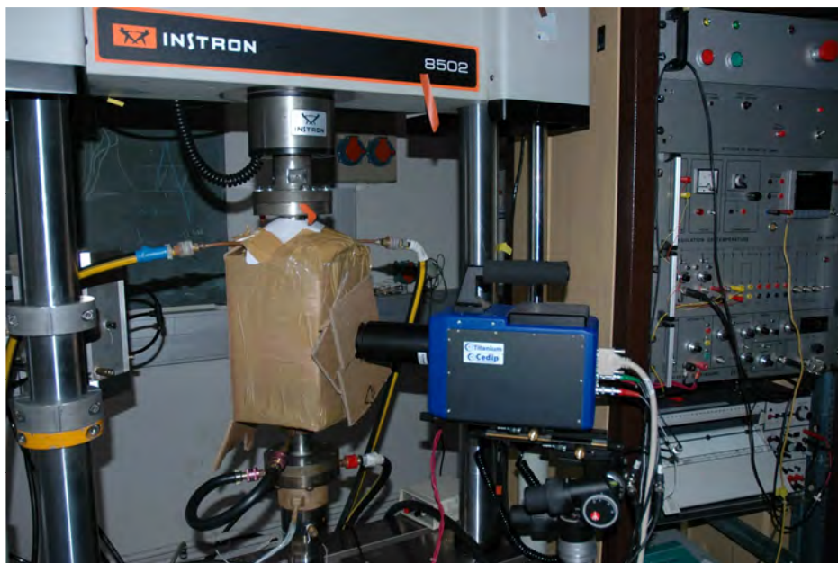
Figure Annexe.13.Montage de l'essai de mesure de champ de contrainte par thermoélasticité
