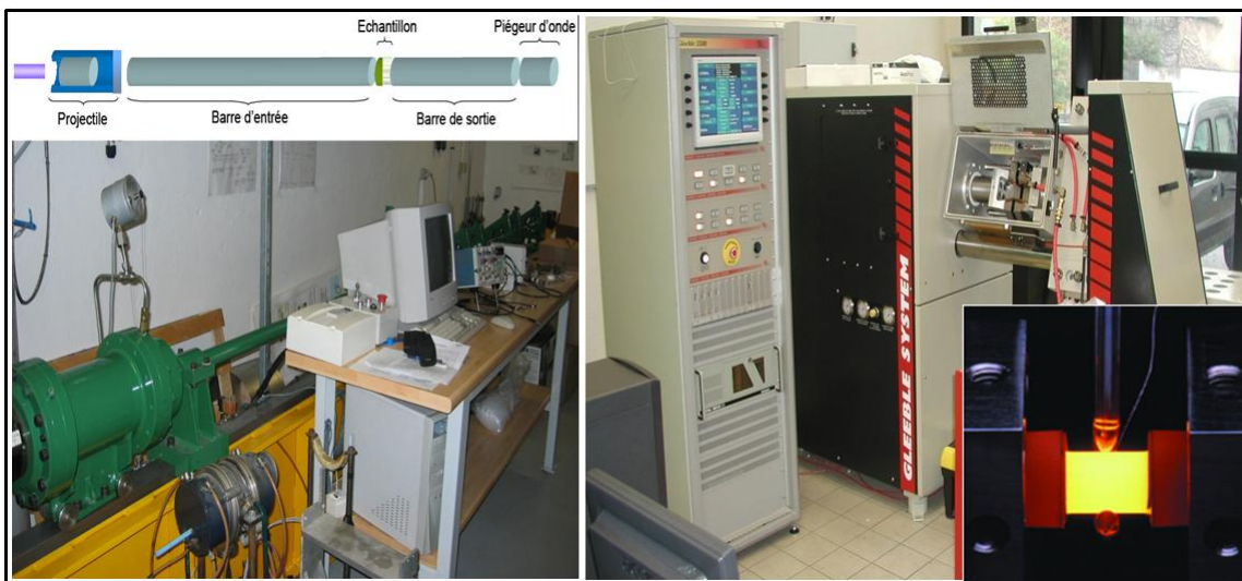
FIGURE 1.15 – Dispositifs expérimentaux des Arts et Métiers ParisTech centre d'Angers : dispositifs barres d'Hopkinson (à gauche), et machine GLEEBLE (à droite).
