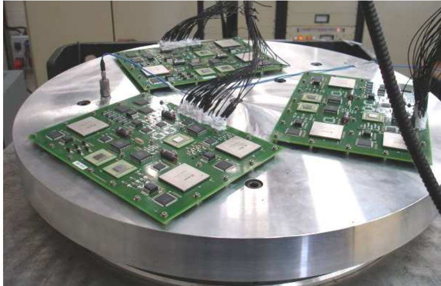
Figure 108 : Photo de l'outillage fixé sur le pot vibrant utilisé pour les essais de la carte B 1
