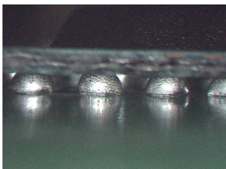
Photo d'un assemblage de type BGA (composant FBGA256)
