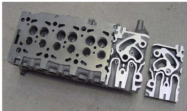
Figure 1.1. Culasse de moteur diesel en alliage d'aluminium de fonderie (PSA)
