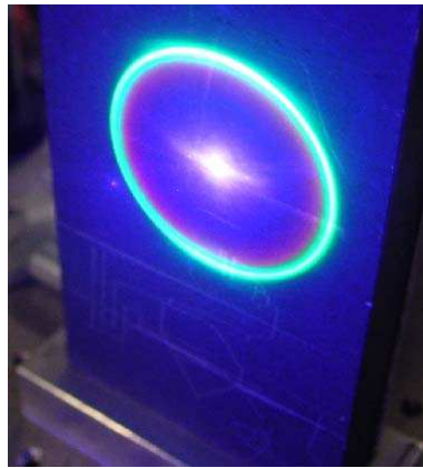
FIG. 2.31: Photo de l'anneau de fluorescence apparaissant autour du faisceau de pompe bleu (à 400 nm) pour une intensité de quelques GW/cm^2
