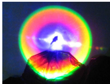
FIG. A.4: Photographie de l'anneau de fluorescence et des points lumineux observés lors d'un effet de cascade
