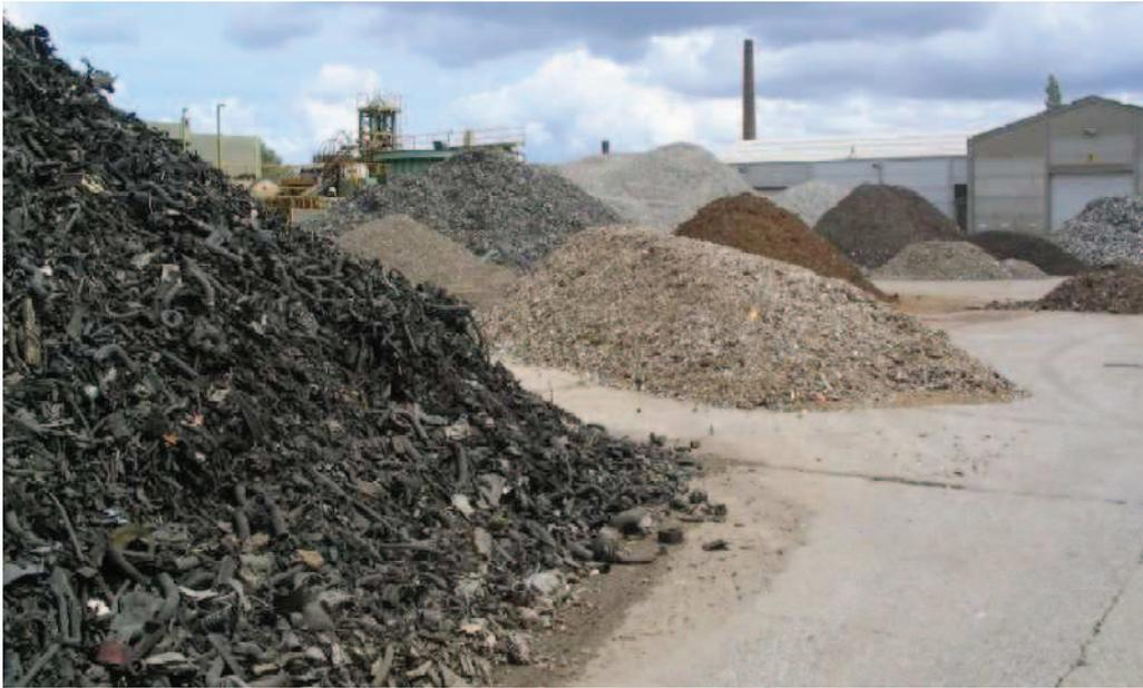
**Figure 25 : Fractions de résidu de broyage en cours de séparation
