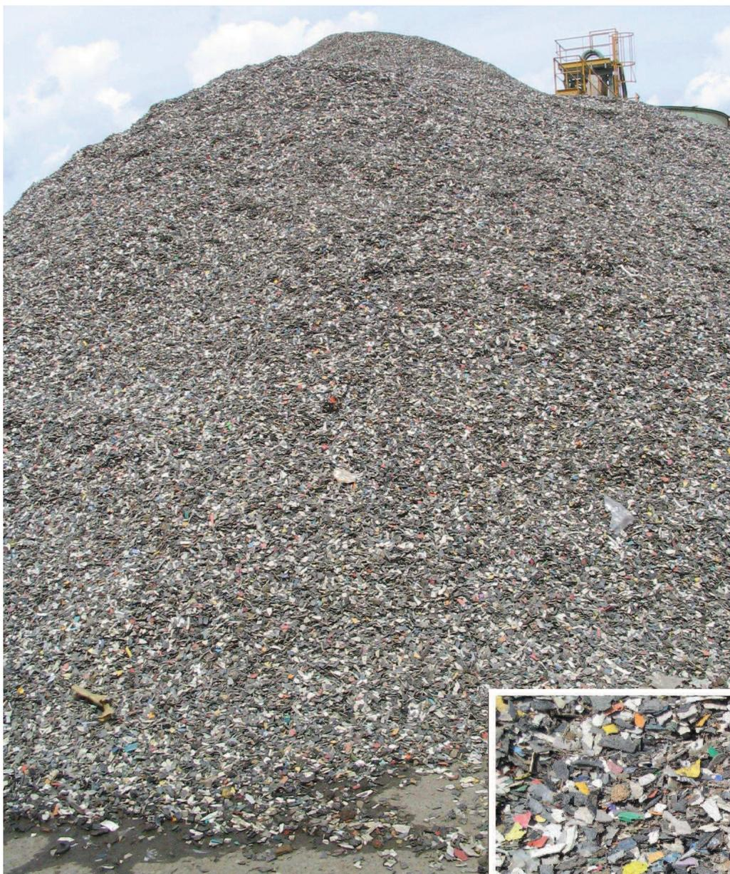
**Figure 26 : Fraction plastique du résidu de broyage (Opérateur : Galloo Metal, Halluin)**
