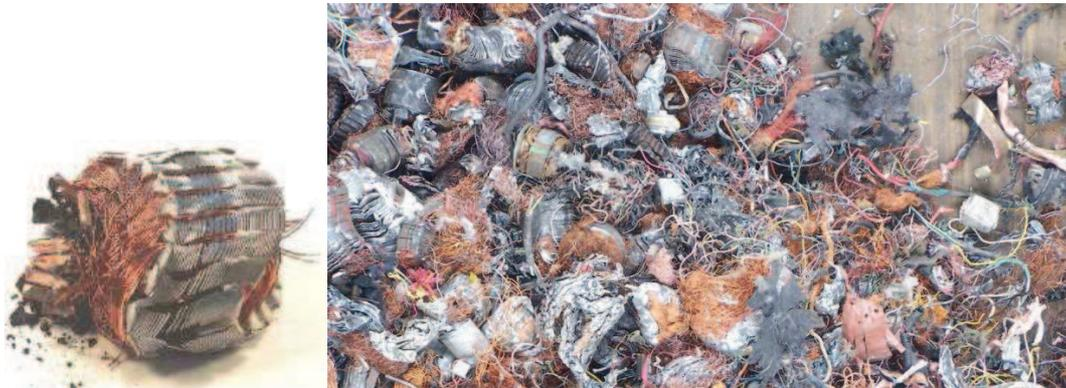
**Figure 29 : Moteur électriques broyés (Source BAUDELET)**
