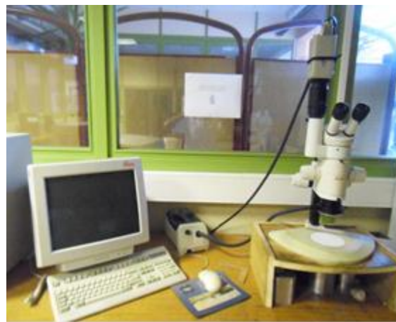
Figure.II.26. Binoculaire utilisée pour mesurer l'usure des plaquettes WC-Co.
