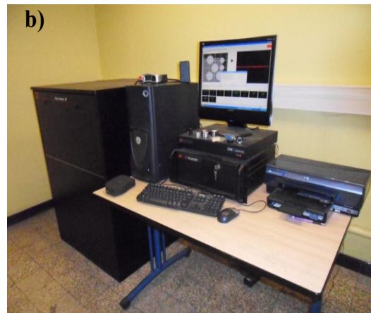
Figure.II.14 : a) Nanoduromètre NHT, b) Nanoduromètre XP MTS.
