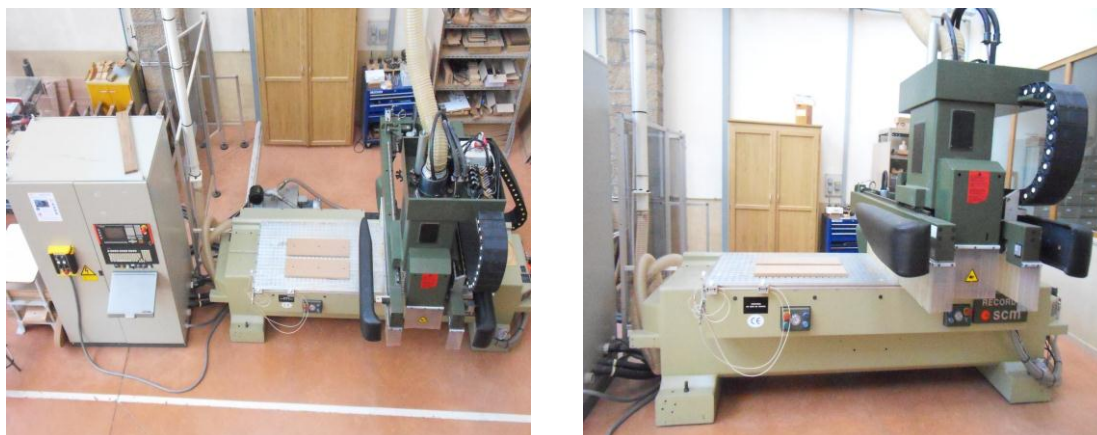
Figure.II.22. Défonceuse 3 axes à commande numérique.
