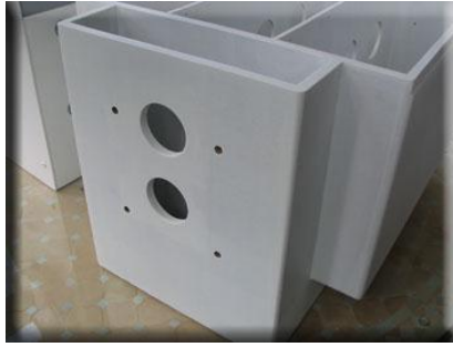
Figure.I.17. Exemple d'une pièce MDF poncée avec un papier de verre P240 puis revêtue avec une couche de primer blanc.
