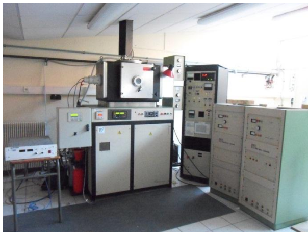
Figure.II.3. Bâti de pulvérisation magnétron NORDIKO 3500.
