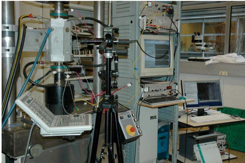
**Figure 1.2-6 : Dispositif général d'un essai de microfissuration**
