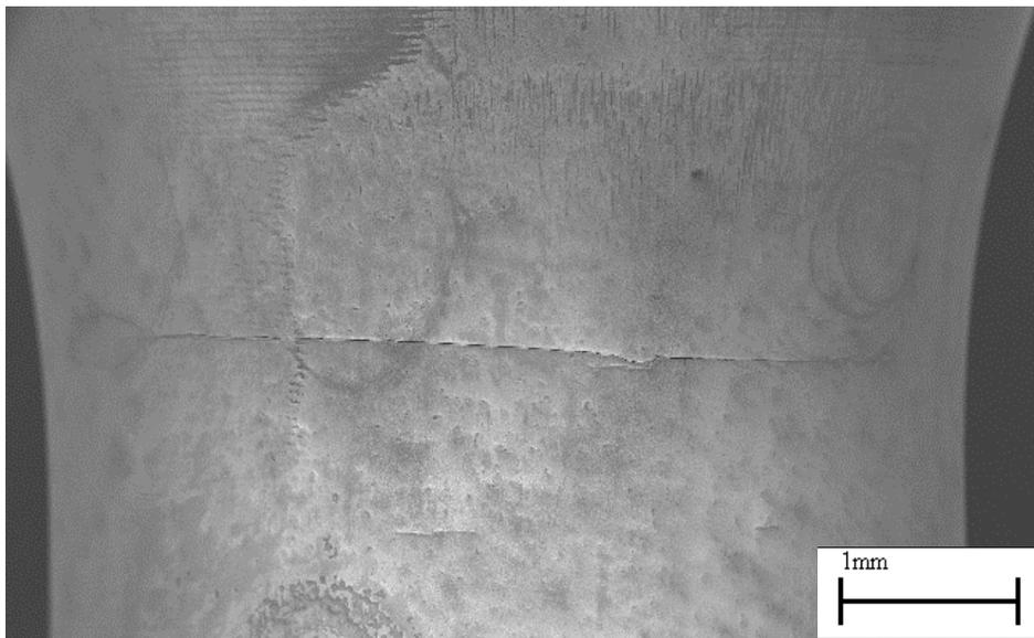
**Figure 2.4-9 : Fissuration de l'éprouvette X2269A (950°C  $\Delta\varepsilon=0.5\%$  f=1Hz)**
