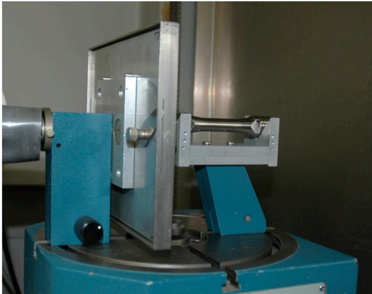
Figure 1.2-1 : Dispositif du montage de Laüe en retour
