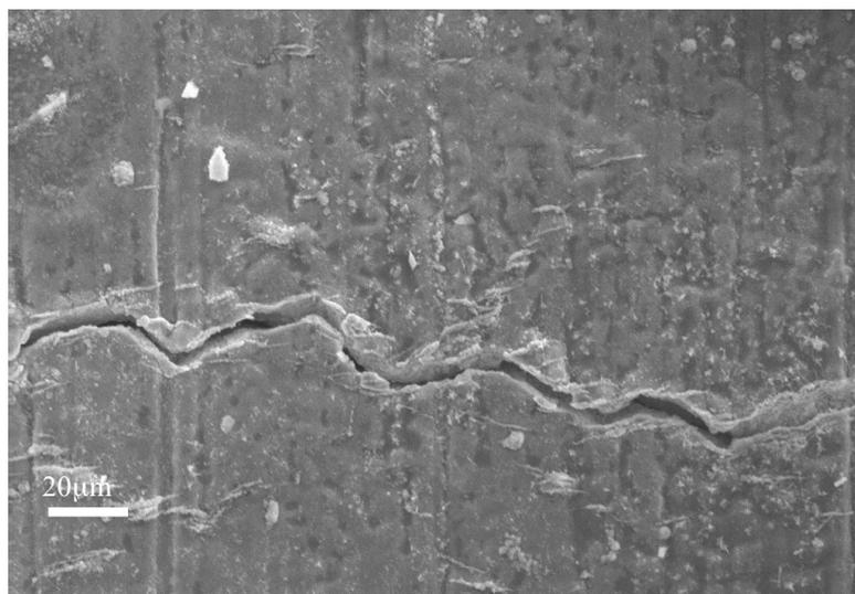
**Figure 2.3-18 : Eprouvette X6660D, 950°C  $f=0.05\text{Hz}$   $\Delta\varepsilon=0.5\%$  :  $a = 500 \mu\text{m}$**
