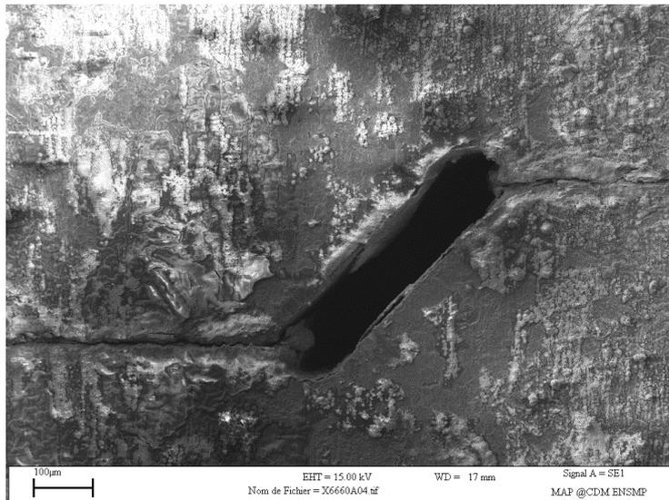
**Figure 3.2-4 : Amorçage et propagation de fissure sur une entaille à 45° X6660A ( $\Delta\varepsilon=0.5\%$   $f=0.05\text{Hz}$   $T = 950^\circ\text{C}$ )**
