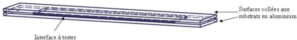
Figure V.3 – Plan des éprouvettes rectifiées pour essais Arcan-Mines sur composite tissé satin 5 de carbone/PPS
