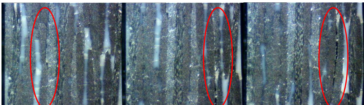
(f) Palier à 95% de la contrainte à rupture moyenne (soit environ 500MPa)
