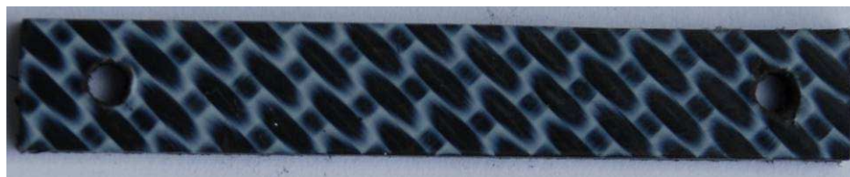
Figure XI.24 – Eprouvette de pendule de torsion (échelle 1/4)
