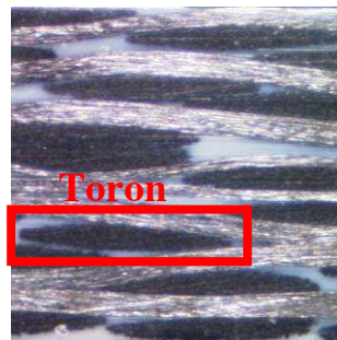
Figure II.3 – Observation par microscopie optique d'un toron d'un carbone/PPS satin 5 consolidée
