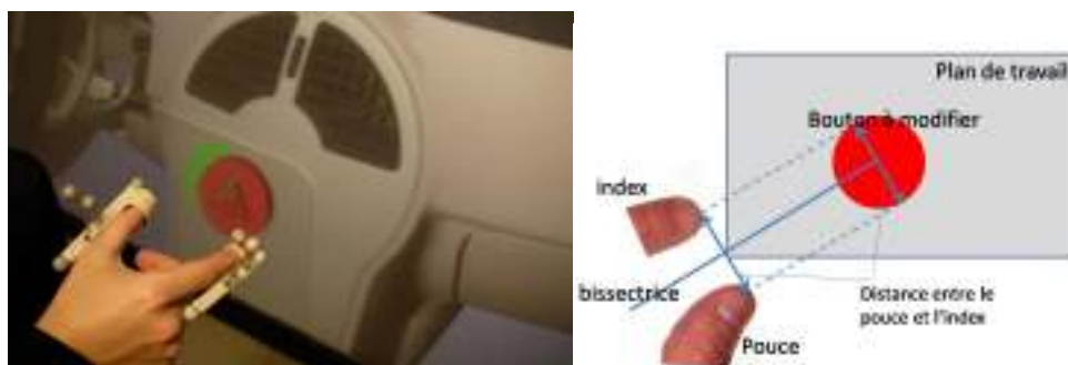
Figure D 4 : Schéma du principe de la méthode d'interaction avec deux doigts suivis
