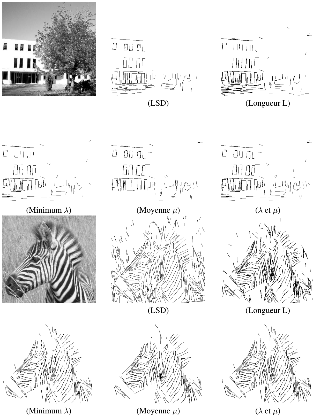
FIG. 2.9 – Détection de segments. Voir section 2.2.10.
