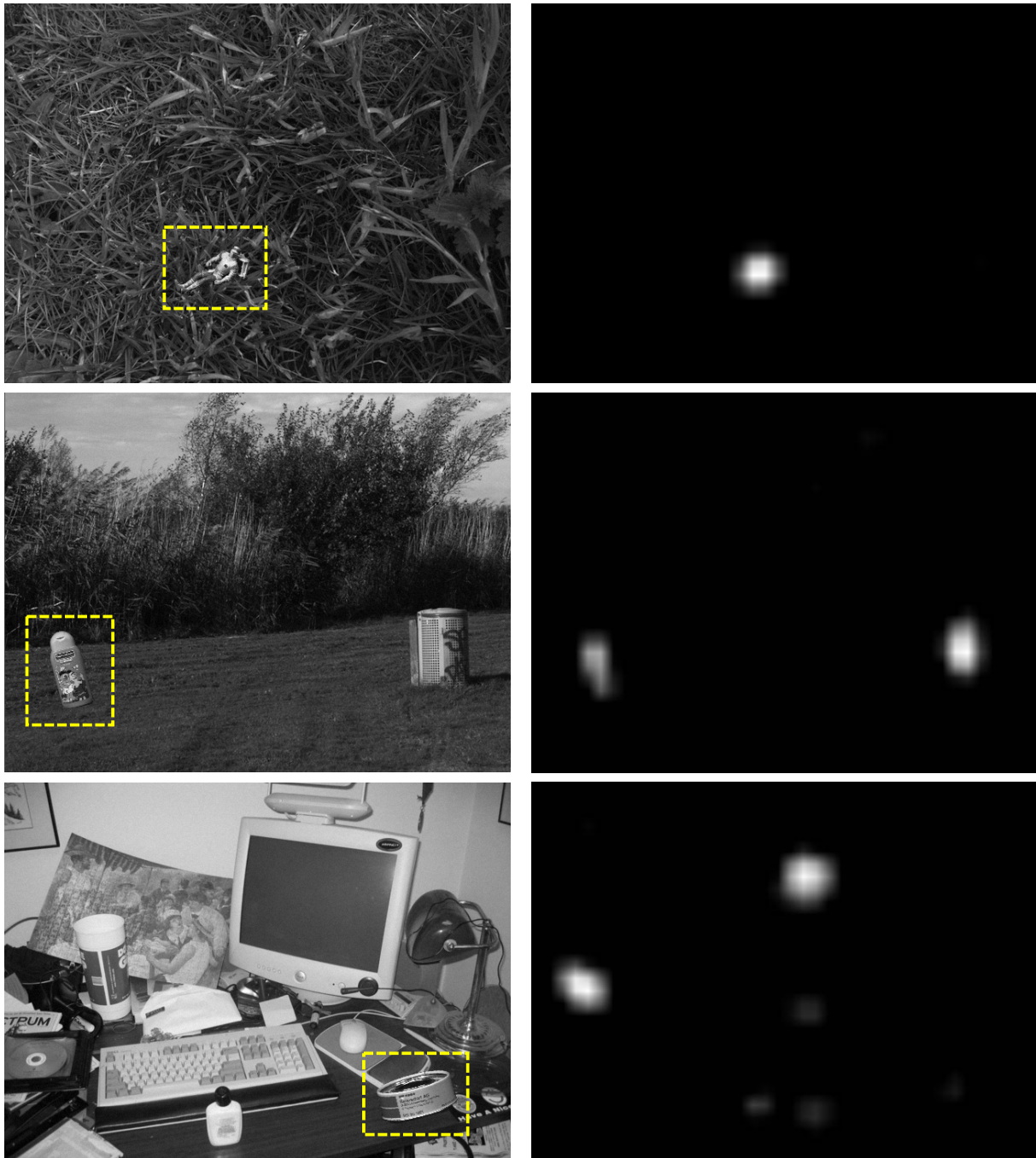
FIG. 4.4 – À gauche : images de test contenant un objet à détecter. À droite : cartes de saillance normalisées calculées par l’algorithme de [IKN + 98], qui mesurent le contraste entre chaque région et sa zone environnante. Ces cartes sont très efficaces pour trouver a priori la position d’objets manufacturés dans des images en extérieur, car ils sont très différents de leur voisinage. En images d’intérieur, cette information est beaucoup moins utile, puisque les objets à détecter ne sont pas nécessairement plus saillants que les autres objets de la scène. Dans l’exemple du bas, les grandes zones sombres et contrastées associées à l’écran et au sac noir (à gauche) sont ainsi plus saillantes que l’objet artificiellement incrusté.
