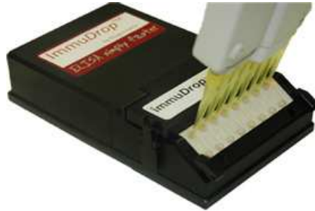
Figure 37. Microsystème dédié à des analyses de type micro-ELISA développé par diagnoSwiss.
