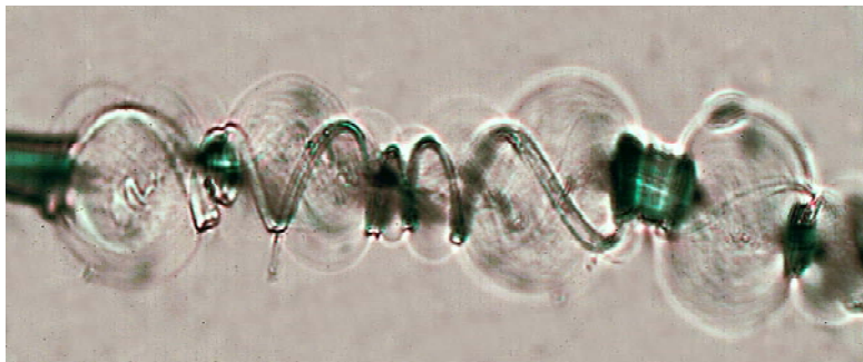
Figure 11 : Formation des ballons dans le coton gonflé par une solution NMMO-eau (photo Le Moigne)
