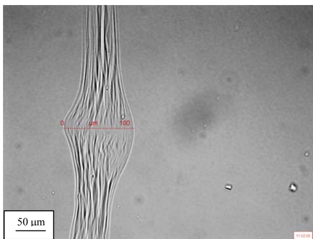
Figure 3 : Exemple de début de gonflement d'une fibre avec et sans tension
