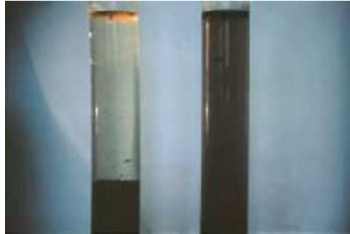
Figure 6 : Mesure de l'indice de boue en éprouvette
