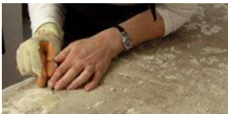
Figure 24 : dégagement de la céruse avec un scalpel sans mesure de sécurité
