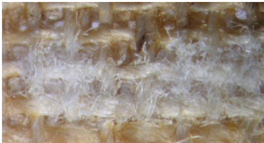
Figure 122 : élimination de la colle de pâte, \lambda : 532 nm, F = 3,15 \text{ J/cm}^2 , 5 pulses, Ablation + , fibres rompues
