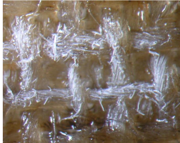
Figure 157 : élimination de la Mowilith® DM5, \lambda : 248 nm, F = 1,78 \text{ J/cm}^2 \cdot 10 \text{ pulses} , Ablation +++
