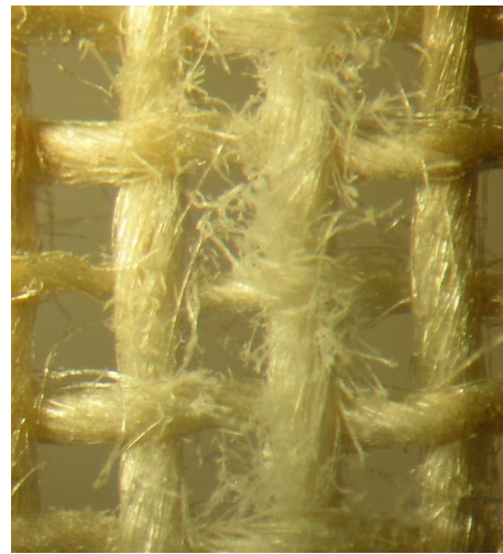
Figure 174 : élimination du Plexisol® P550, \lambda : 532 \text{ nm} , F = 3,15 \text{ J/cm}^2 \cdot 5 \text{ pulses} , décoloration des fibres
