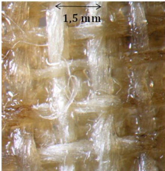
Figure 162 : élimination de la Mowilith® DM5, \lambda : 532 nm, F = 1,87 \text{ J/cm}^2 .5 pulses, décoloration des fibres
