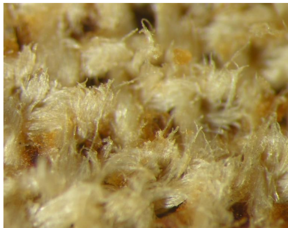
Figure 20 : fibres de toile élimées par le scalpel
