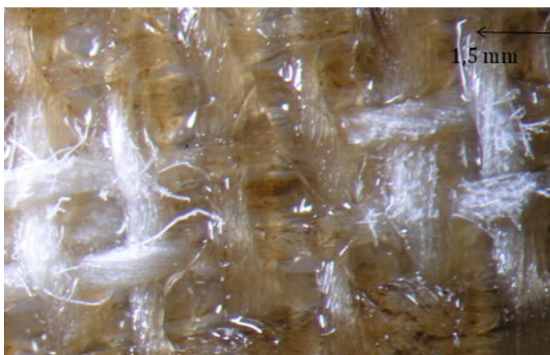
Figure 160 : élimination de la Mowilith® DM5, \lambda : 355 nm, F = 2 \text{ J/cm}^2 \cdot 40 \text{ et } 10 \text{ pulses} , Ablation ++
