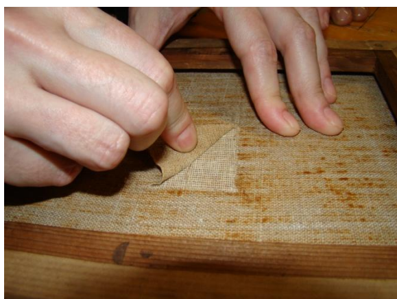
Figure 21 : Arrachage de la toile de rentoilage. La gaze sous-jacente apparaît, elle sera retirée.
