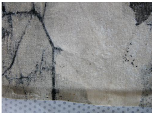
Figure 26 e : revers de l'échantillon après le retrait du doublage : PVAc restant sur le revers de la toile
