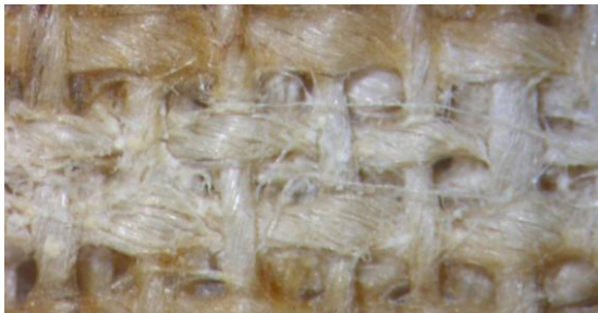
Figure 121 : élimination de la colle de pâte, \lambda : 532 nm, F = 1,87 \text{ J/cm}^2 , 5 pulses, Ablation +++
