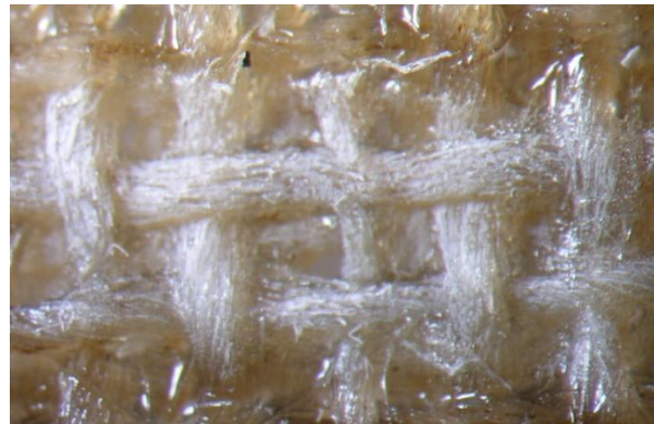
Figure 159 : élimination de la Mowilith® DM5, \lambda : 248 nm, F = 2,5 \text{ J/cm}^2 \cdot 40 \text{ pulses} , Ablation +++
