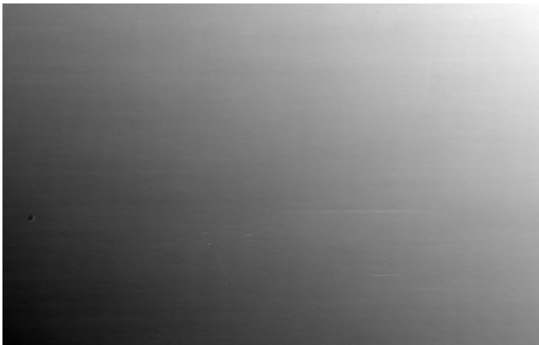
FIGURE 4.14 – Topographie d'une tôle polie (grandissement x1.6), interpolée par une régression linéaire supportée par les frontières.
