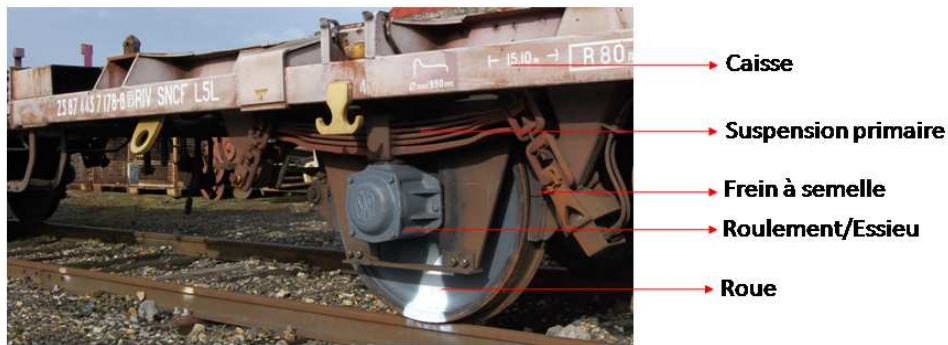
FIGURE 1.5 – Description des composants du véhicule.
