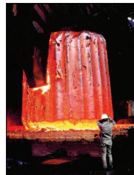
(c) Lingot de 600 tonnes destiné à produire des pièces maîtresses de réacteurs nucléaires [FrM09]
