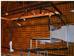
Montage d'une cavité dans une soufflerie anéchoïque
