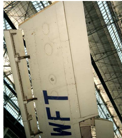
Évacuation de carburant ("Burst-disk")
